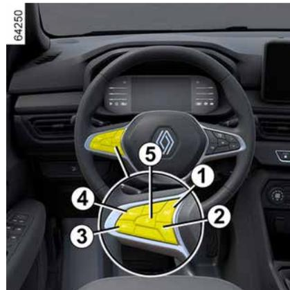
A velocidade limitada pode ser alterada pressionando repetidamente ou mantendo pressionado :
