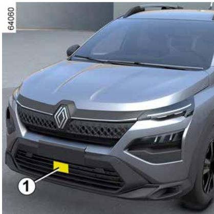
Usando as informações do sensor **1**, esta função informa o motorista sobre o intervalo de tempo entre o seu veículo e o veículo da frente para manter uma distância de parada segura entre os dois veículos.
