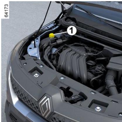
Com o motor parado e em solo horizontal, o nível **a frio** deve se situar entre as marcas “MINI” e “MAXI” indicadas no bocal **1**.
