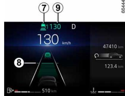
Se tentar ativar a função quando a velocidade do veículo for superior a 160 km ou inferior a 30 km/h em veículos equipados com caixa de câmbio automática, a mensagem “Veloc. inválida” será exibida e a função não será ativada.
