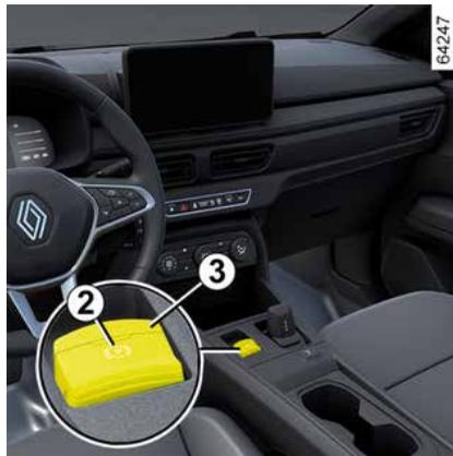
Você pode aplicar o freio de estacionamento eletrônico manualmente.
