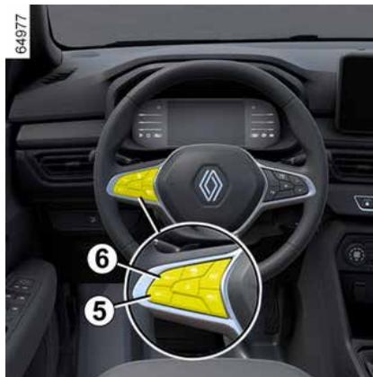
Enquanto o veículo estiver se movendo a uma velocidade constante, pressione o interruptor **5** (SET/-) ou **6** (RES/+) para ativar a função e armazenar a velocidade atual. A velocidade de cruzeiro mínima registrada é de 30 km/h.
