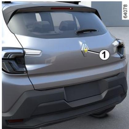
Quando a marcha a ré é engatada, a câmera **1** mostra uma visão da área atrás do veículo no visor multimídia **2**, acompanhada por duas linhas-guia móveis ou fixas **3** e **4**.
