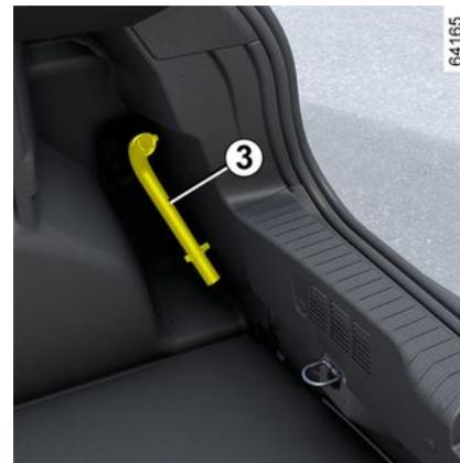
Trava ou destrava os parafusos da roda.
