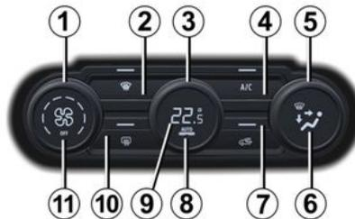
1. Regulagem da velocidade de ventilação.
