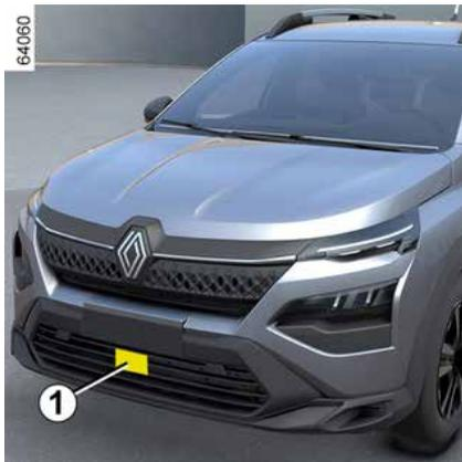
Usando os dados do sensor **1**, o sistema calcula a distância que separa o veículo :
