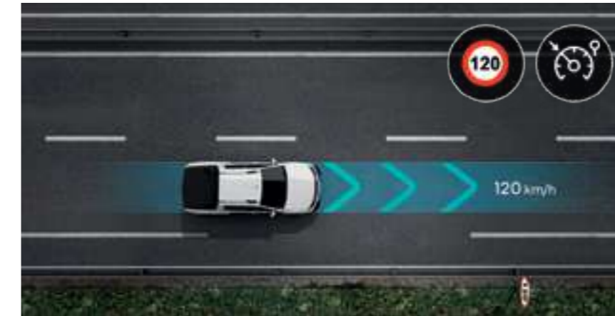
limitador e controlador de velocidade Controla a sua velocidade usando botões no volante para reduzir o risco de transgressões de velocidade.
