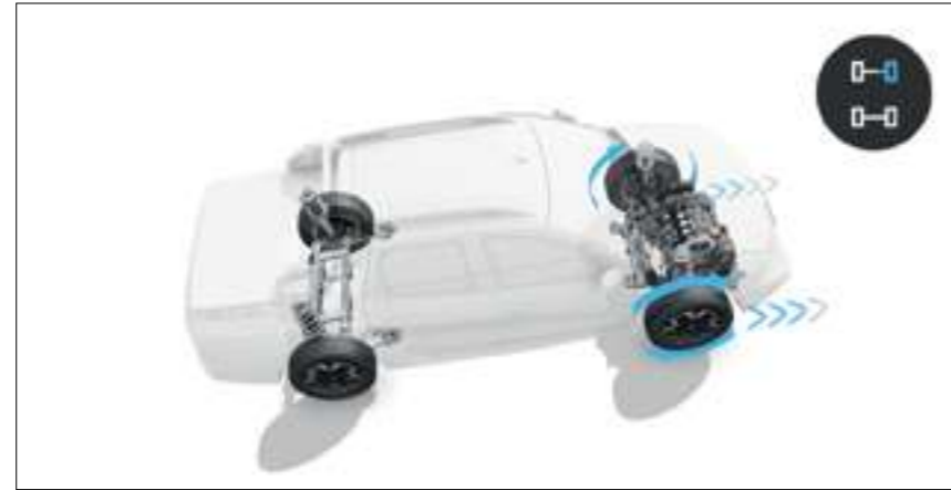
controle de tração Limita o deslizamento das rodas durante a partida, a aceleração e a frenagem.
