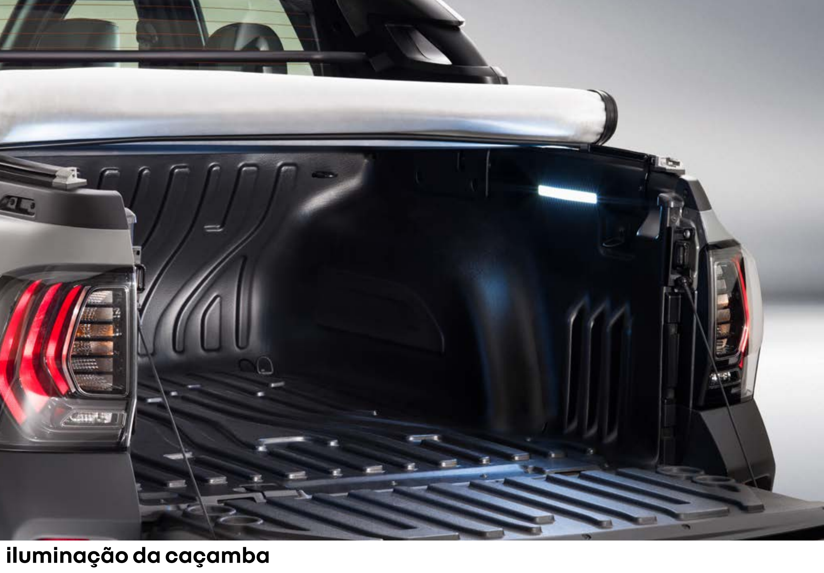
iluminação da caçamba
