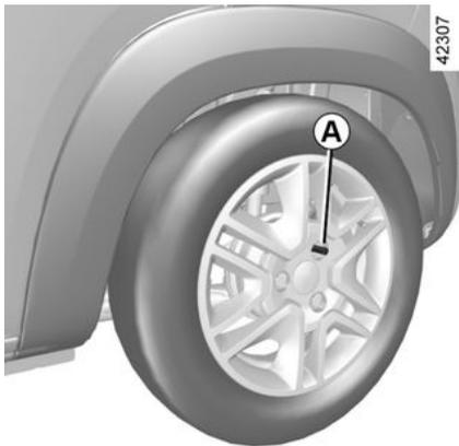
Coloque o estepe ou a roda reparada alinhando um dos orifícios com o pino auxiliar de montagem **A** do cubo/disco.
