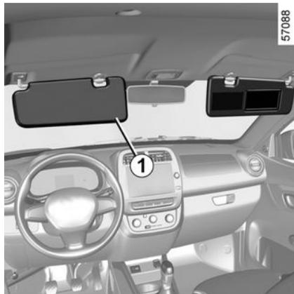
Abaixe o para-sol **1** em direção ao para-brisa ou desencaixe-o e o desloque em direção o vidro lateral.
