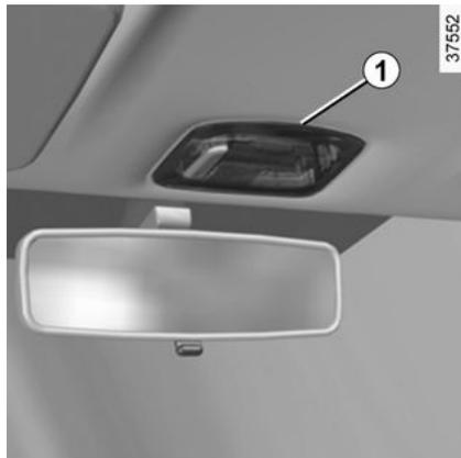
Solte a luz de teto **1** com uma ferramenta do tipo chave de fenda.
