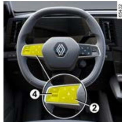
A função do limitador de velocidade é suspensa quando você pressiona o interruptor 2 (0).
