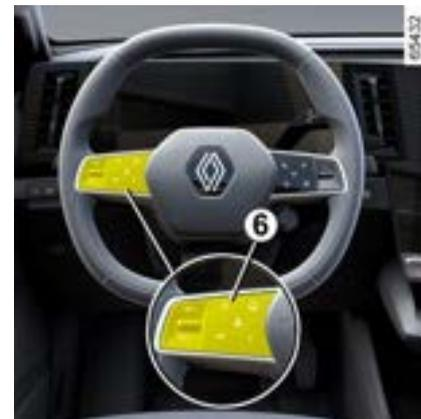
Para adaptar o ponto de ajuste do limitador de velocidade, controle de cruzeiro ou controle de cruzeiro adaptativo ao limite de velocidade detectado, pressione o interruptor 6.
