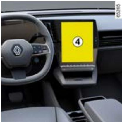
Com o veículo parado, no mundo "Veículo" que aparece na tela de multimídia 4, pressione o menu "Assistente de estacionamento".
