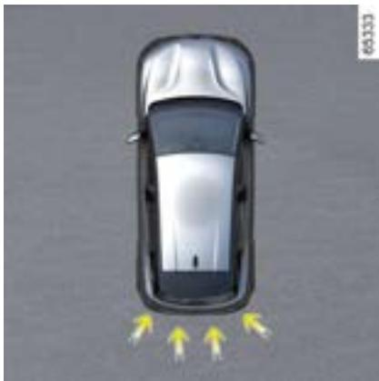
Além da função "Assistente de estacion." → 287 e usando as informações dos quatro sensores centrais localizados na parte traseira do veículo, o sistema detecta obstáculos fixos localizados atrás do veículo. Se houver um risco significativo de colisão, o sistema automaticamente fará com que o veículo freie.
