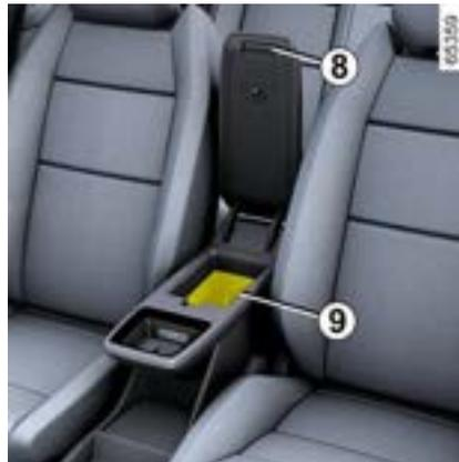
Dependendo do veículo, levante a tampa do apoio de braço deslizando pressionando o botão **8**.
