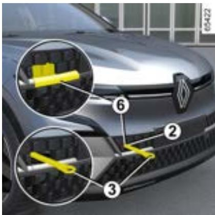
Puxe a peça **6** para removê-la e acessar o ponto de reboque dianteiro **2**. A peça **6** é anexada para evitar que seja perdida.
