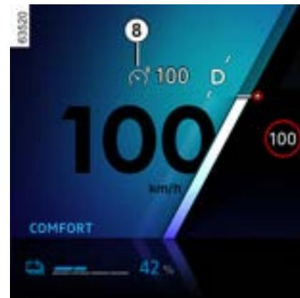
A função do limitador de velocidade é interrompida quando você pressiona o botão **1** para desmarcar o limitador. Nesse caso, a velocidade não é mais armazenada
