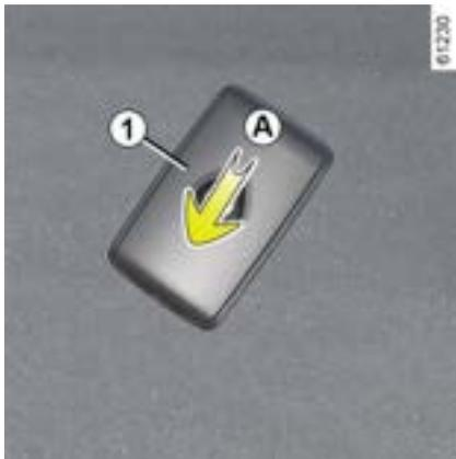
Quando a mensagem "Bateria do cartão fraca" aparecer no painel de instrumentos, substitua a bateria do cartão:
