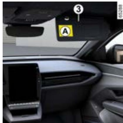
As marcações no painel e as etiquetas **A** de cada lado do para-sol do passageiro 3 (como a etiqueta acima) servem para lembrar você de que não deve colocar uma criança em uma cadeirinha voltada para a traseira do veículo quando o airbag do passageiro estiver ativado.
