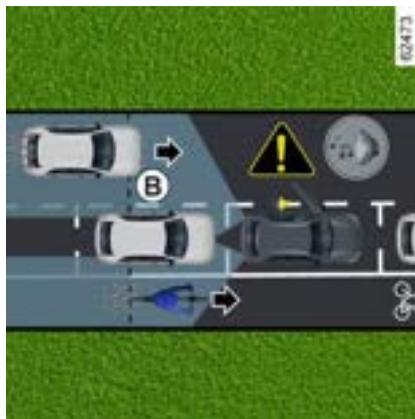
Usando informações dos sensores instalados em cada lado do para-choque traseiro (área **C**), a função avisa o motorista:
