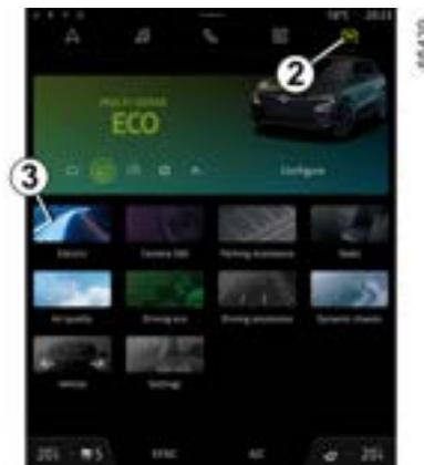
Com o veículo parado e o motor ligado, no mundo "Veículo" **2** na tela multimídia **1**, pressione o menu "Elétrico" **3** e, em seguida, a lingueta "Carregamento e Ar condicionado" para programar o carregamento do veículo.
