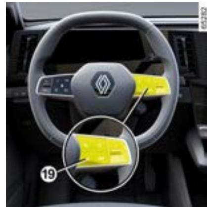
Dependendo do veículo, ao pressionar o controle do volante **19**, você pode ativar as seguintes funções de acordo com as configurações do usuário armazenadas definidas anteriormente:
