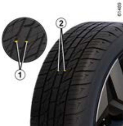
Os pneus devem estar em bom estado e os sulcos devem apresentar uma profundidade satisfatória. Os pneus homologados por nossos serviços técnicos incluem marcas indicadoras de desgaste **1** que são constituídas por **saliências incorporadas nos sulcos da banda de rodagem**.
