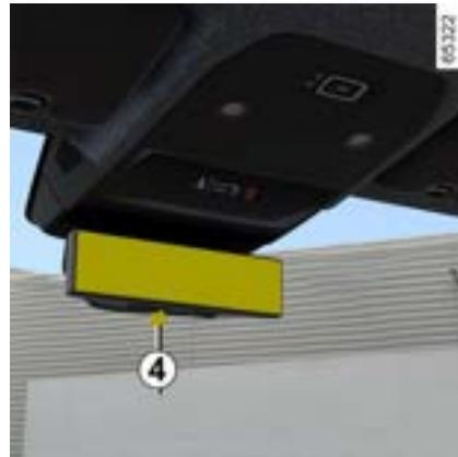
Em condução noturna, para não ser ofuscado pelos faróis do veículo em sua traseira, ajuste a pequena alavanca do espelho **4** situada por trás do retrovisor.
