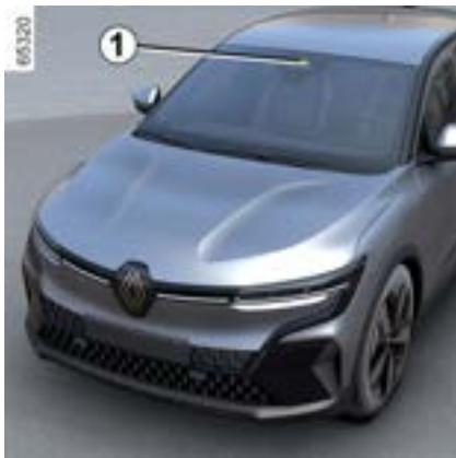
Usando as informações da câmera **1**, a função aciona uma ação corretiva no sistema de direção do veículo quando uma linha contínua ou tracejada é cruzada ou quando ele está se aproximando da lateral da pista (divisor, barreira, pavimento, contenção etc.) sem ativar as luzes indicadoras de direção.
