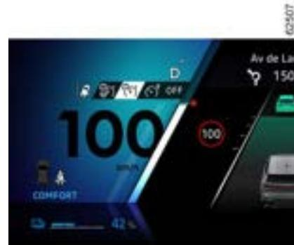
Pressione o interruptor **3** quantas vezes forem necessárias para selecionar o piloto automático adaptativo. A luz indicadora **10** acende em cinza. A mensagem "adapt. cruise control pronto: SET para ativar" é exibida no painel de instrumentos acompanhada de traços para indicar que a função de piloto automático está em operação e aguardando para armazenar uma velocidade de cruzeiro.
