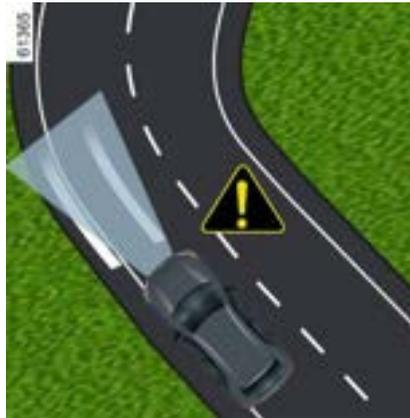
No caso de uma curva fechada e, dependendo da velocidade do veículo, as capacidades de retenção lateral da função serão limitadas e exigirão que o motorista tome uma medida imediata ao volante para que o veículo permaneça no centro da faixa.
