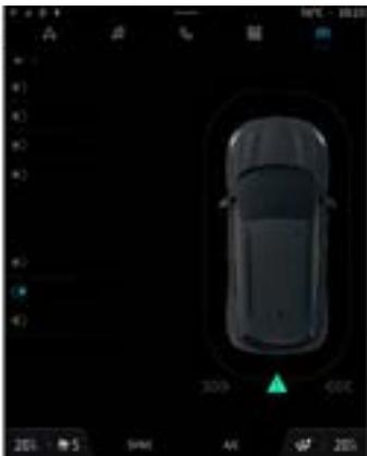
Para ativar ou desativar a função através da tela de multimídia **1**, selecione o mundo "Veículo" e, em seguida, "Assistente de estacionamento". Selecione "Frenagem traseira de emergência ativa".
