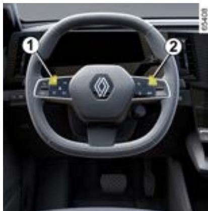
Dependendo do veículo, os pedais 1 e 2 podem ser usados para alterar o nível de frenagem regenerativa quando a alavanca de câmbio está na posição D.
