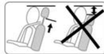
**A posição totalmente abaixada do apoio de cabeça é somente para armazenamento:** essa posição não deve ser utilizada quando o assento estiver ocupado.
