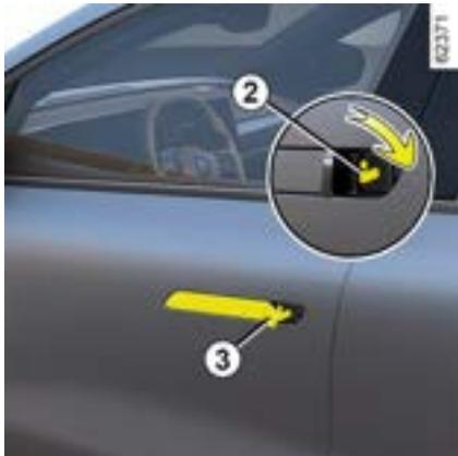
Mova a tampa da fechadura **3** pressionando a parte esquerda e insira a chave **2** na fechadura para travar ou destravar a porta do motorista.
