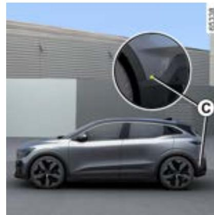
Certifique-se de que a zona **C** ao redor dos radares em cada lado do para-choque traseiro não está obstruída (por sujeira, lama, neve etc.).
