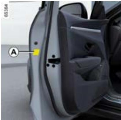
Para ler, abra a porta do motorista. As pressões de enchimento devem ser verificadas com pneus frios. Caso a verificação das pressões não possa ser efetuada com os pneus frios, será necessário aumentar as pressões de 0,2 para 0,3 bar (ou 3 PSI). Nunca esvazie um pneu quente.
