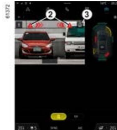
Se o veículo estiver equipado com uma barra de reboque reconhecida pelo sistema e um reboque estiver ligado, a frenagem de emergência ativa em marcha à ré será desativada automaticamente e a mensagem "reboque: sensor estacionamento indisponíveis" aparecerá no painel de instrumentos, acompanhado pela luz
