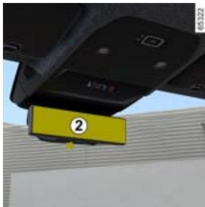
Quando a ignição é ligada, o espelho retrovisor **2** montado no console central do teto exibe a visão atrás do veículo que é transmitida pela câmera **1**.
