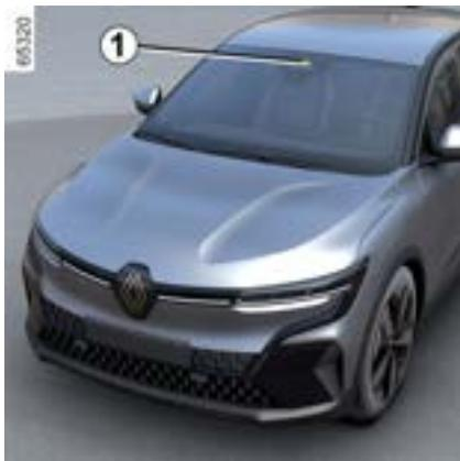
O sistema exibe os limites de velocidade no painel de instrumento de acordo com as placas detectadas na margem da estrada.
