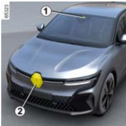
Usando informações da câmera **1** e do radar **2**, o sistema determina a distância entre seu veículo:
