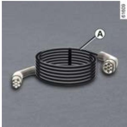
Este cabo é específico para seu veículo e projetado para conexão a tomadas elétricas ou terminais públicos para permitir o carregamento padrão da bateria de tração.
