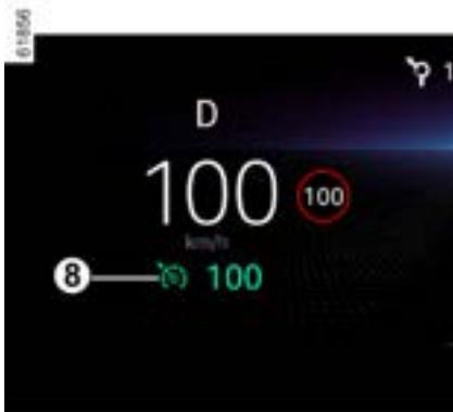
A luz indicadora **8** acende em cinza. A mensagem "cruise contr. OK SET para ativar" é exibida no painel de instrumentos acompanhada por traços para indicar que a função de controle de cruzeiro está em operação e aguardando para armazenar uma velocidade de cruzeiro.
