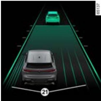
Para ativar a posição na faixa, a função "Centralização na faixa" deve estar em modo de ajuste, a luz indicadora verde **22** deve ser exibida no painel de instrumentos e a velocidade do veículo deve ser inferior a 50 km/h.
