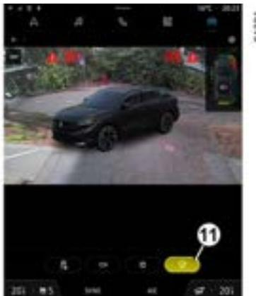
Na tela multimídia, pressionando o botão dedicado **11**, você obtém uma visão 3D permitindo que visualize o veículo e os arredores em três dimensões.
