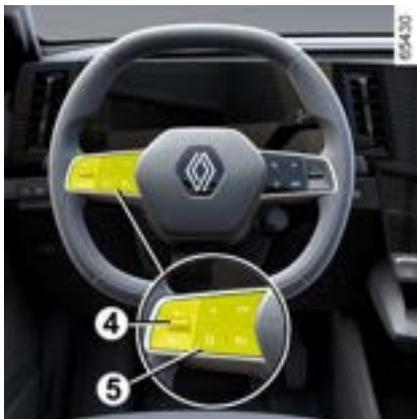
A função do limitador de velocidade é suspensa quando você pressiona o interruptor **5** (0).
