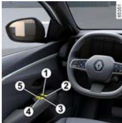
Pressione ou puxe rapidamente o interruptor do vidro até seu limite: o vidro será totalmente levantado ou abaixado. Uma nova ação no interruptor interrompe o movimento do vidro.
