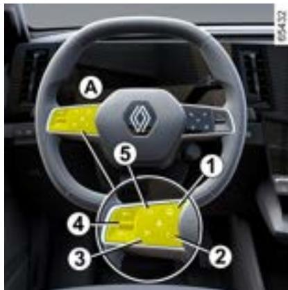
**1.** Interruptor para selecionar/desmarcar os auxiliares de condução, dependendo do veículo:
