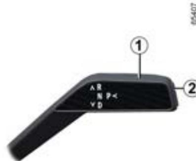
Com o veículo parado e o motor ligado ou ignição ligada, pressione o botão 2 para engatar a posição P.
