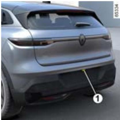
Quando a marcha a ré é engatada, a câmera **1** localizada na traseira do veículo transmite uma visão da área atrás do veículo no visor multimídia **2**, acompanhada de uma a três gabaritos **3**, **4** ou **5** (gabaritos fixos, móveis ou reboque).
