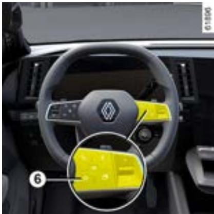
Dependendo do veículo, ao pressionar o controle do volante **6**, você pode ativar o volante aquecido de acordo com as configurações de uso armazenadas definidas anteriormente.
