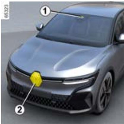
Usando a informação do radar **2** e da câmera **1**, esta função informa o motorista sobre o intervalo de tempo entre o veículo e o veículo da frente para que uma distância de parada segura entre os dois veículos possa ser mantida.
