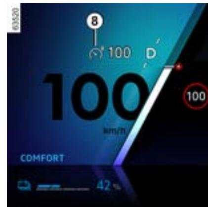
A luz indicadora 8 acende em cinza. A mensagem "Limitador de velocidade pronto: SET para ativar" é exibida no painel de instrumentos acompanhada de traços para indicar que a função do limitador de velocidade permanece ativada e aguarda o armazenamento de um limite de velocidade.
