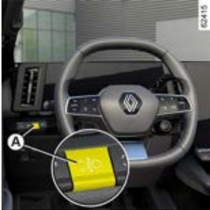
Dependendo do veículo, o interruptor **A** pode ser usado para ajustar a altura dos faróis de acordo com a carga.
