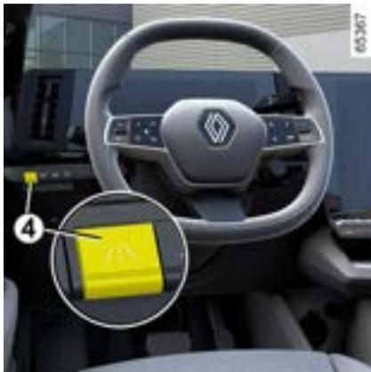
Antes de ativar a função, no Mundo "Veículo" na tela de multimídia 2, pressione o menu "Assistente de condução" e, em seguida, selecione o menu "Sistema de manutenção de pista" e selecione "Aviso de saída de pista".
