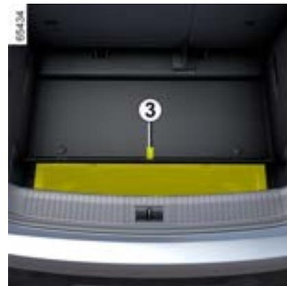
Bandeja destinada para cabos de carregamento. O peso máximo permitido na bandeja é de 10 kg.
