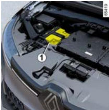
A bateria secundária é uma bateria de 12 V: ela fornece a energia necessária para operar o equipamento do veículo (luzes, limpadores de para-brisa, janelas, sistema de áudio etc.) e determinados sistemas de segurança, como assistência de frenagem.
