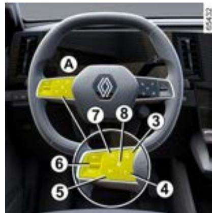
**3.** Interruptor para selecionar/desmarcar os auxiliares de condução, dependendo do veículo:
