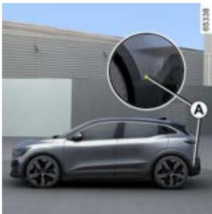
Usando informações dos radares instalados em cada lado do para-choque traseiro (área **A**), o sistema notifica o motorista quando outro veículo aparece na zona de detecção **B**.
