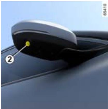
A câmera **2**, instalada no retrovisor da porta, transmite uma visão lateral para a tela multimídia **5**.
