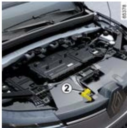
Levante o capô alguns centímetros e empurre a alavanca **2** para a esquerda.
