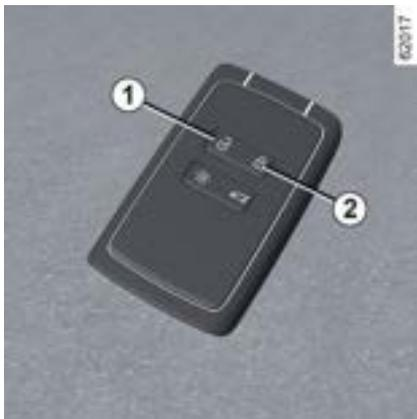
Quando o veículo estiver equipado com travamento elétrico, isso permite bloquear as partes que podem ser abertas e assim impedir a abertura das portas pelas maçanetas internas (como no caso, por exemplo, de uma quebra de um vidro seguida de uma tentativa de abertura das portas pelo lado interno).
