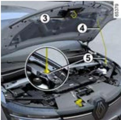
Após levantar o capô e desengatar o suporte **4** da montagem **3**, por segurança, você **deve** posicionar o suporte em **5**.
