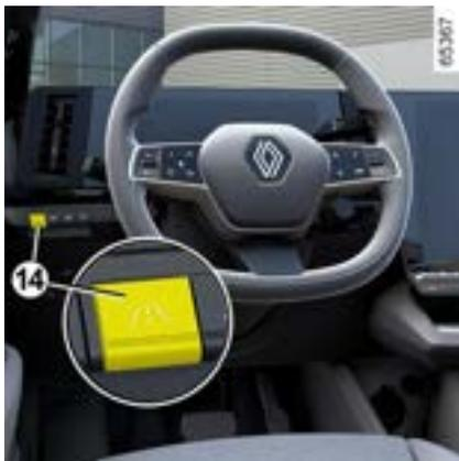
**Nota:** para os veículos equipados com o sistema "Active driver assist" → **272**, quando a função "Assistência de centralização da pista.", selecionada anteriormente no sistema multimídia ou, dependendo do veículo, pressionando o interruptor **14** (luz indicadora do interruptor **14** acesa), o piloto automático adaptativo é ativado automaticamente quando a função
