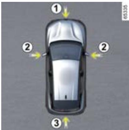
Usando informações de câmeras **1**, **2** e **3** localizadas no para-choque dianteiro, retrovisores e na tampa do porta-malas, além de detectores ultrassônicos **4** localizados nos para-choques do veículo, o recurso auxilia em manobras difíceis (por exemplo, estacionamento) exibindo os arredores do veículo.
