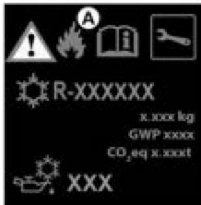
O circuito do fluido refrigerante (em que alguns componentes são hermeticamente selados) pode conter gases fluorados de efeito estufa.
