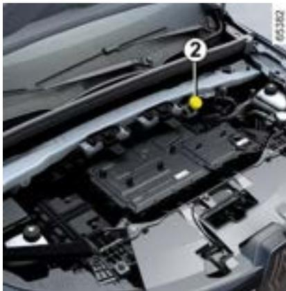
A verificação do nível é efetuada com o motor parado e em piso horizontal. Deve ser verificado com frequência e sempre que sinta uma diferença, ainda que ligeira, na eficácia do sistema de frenagem.
