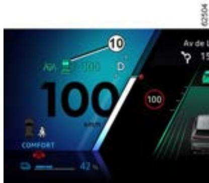
O radar é capaz de detectar veículos na frente do seu veículo. O sistema não pode operar corretamente se a área de detecção do radar estiver obscurecida ou se seu sinal for interrompido.
