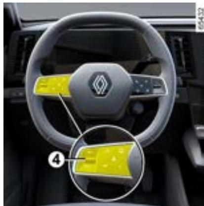
Você pode alterar a velocidade limite pressionando repetidamente ou mantendo pressionado o controle **4**:
