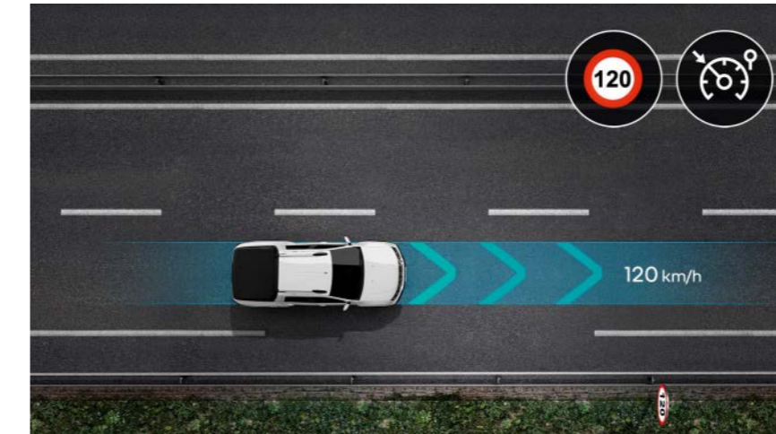
limitador e controlador de velocidade Controla a sua velocidade usando botões no volante para reduzir o risco de transgressões de velocidade.
