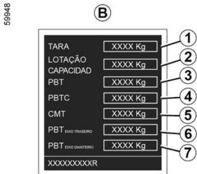
Indicação de pesos e capacidades do veículo **B**, localizada na coluna da porta do lado esquerdo.
