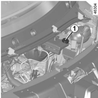
Deve ser verificado com frequência e sempre que sinta uma diferença, ainda que ligeira, na eficácia do sistema de frenagem.
