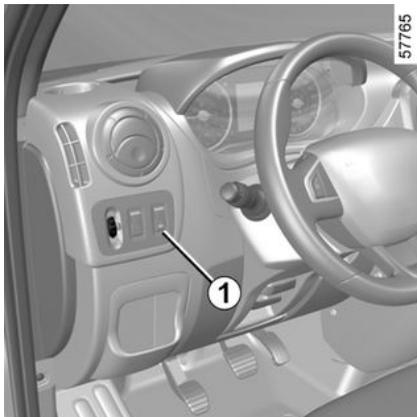
Pressione o interruptor **1**: a mensagem "Modo off-road ativado" aparece no painel de instrumentos.
