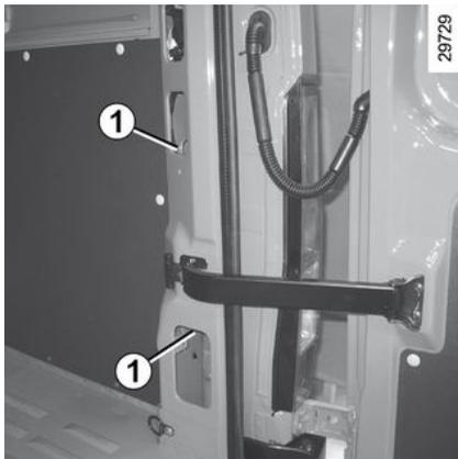
Conforme a versão do veículo, retire as grades de proteção. Desaperte as duas porcas **1** e puxe pelas lanternas traseiras **A**.
