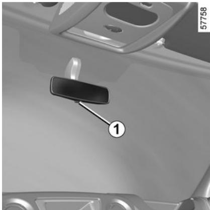
O retrovisor interno é orientável. Em condução noturna, para não ser ofuscado pelos faróis de um veículo que o segue : oscile a pequena alavanca **1** situada atrás do retrovisor.
