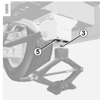
Se o estepe for fornecido com parafusos, utilize exclusivamente neste estepe. Aperte os parafusos assegurando a correta colocação da roda no seu cubo e desaperte o macaco.
