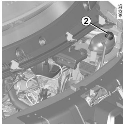
Com o motor parado e em terreno horizontal, o nível **quando frio** deve estar entre as marcas "MINI" e "MAXI" no reservatório do líquido de refrigeração **2**.
