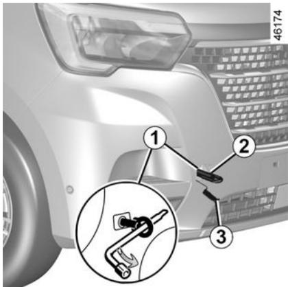
– Na frente, o anel de reboque 2 (situado no conjunto de ferramentas) e o ponto de reboque 1.
