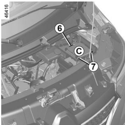
Encaixe as fixações 7, depois a fixação 6.
