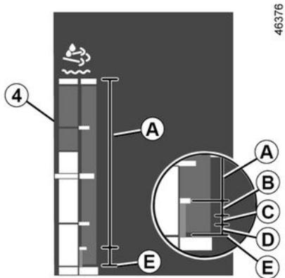
A luz indicadora é exibida de acordo com o nível de reagente indicado pelo medidor 4 no painel de instrumentos.
