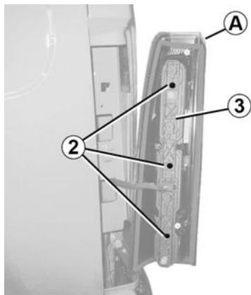
Desaperte os parafusos **2** com a chave plana / chave de fenda para retirar o porta-lâmpadas **3**.
