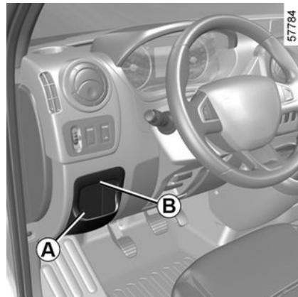
Desencaixe a tampa **A** utilizando o entalhe **B**.
