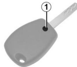
Desaperte o parafuso **1** para retirar a tampa do controle remoto.
