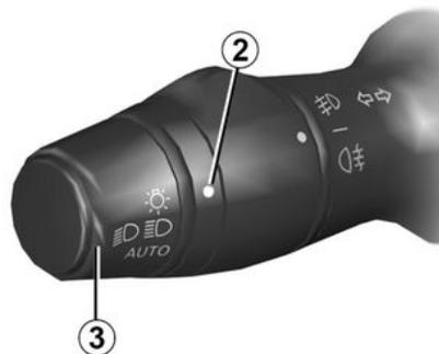
Os faróis diurnos acendem automaticamente sem intervenção na haste **1** quando se dá partida no motor e apagam quando o motor é desligado.
