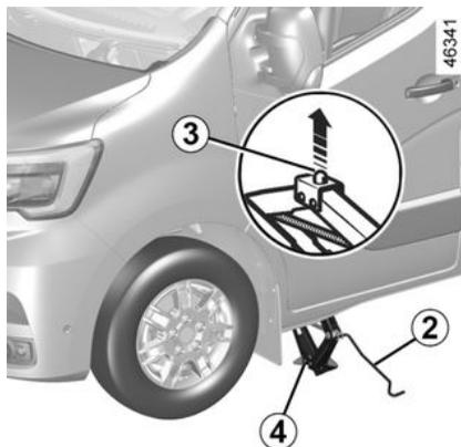
Posicione o macaco **4** horizontalmente. A cabeça do macaco **3** deve ser posicionada na altura do reforço da chapa o mais próximo da roda a ser substituída ou dos pontos de apoio **5**;
