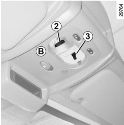
Desencaixe (com uma chave de fendas) a tampa da luz de teto.
