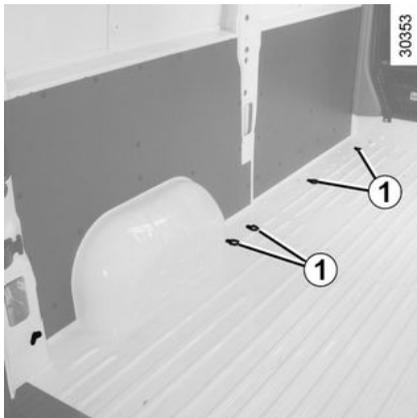
Conforme a versão do veículo, os anéis **1** e **2** permitem a retenção dos objetos transportados. O número de anéis e a respectiva localização podem variar conforme a versão do veículo.
