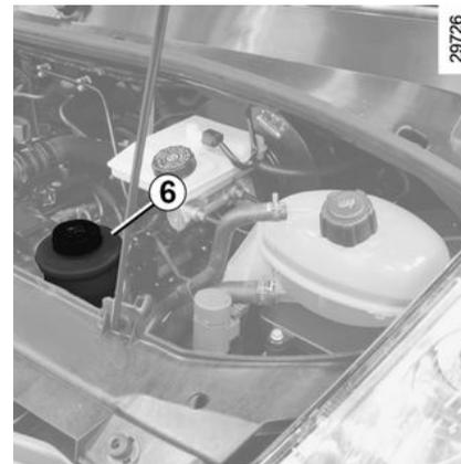
**Nível :** para um nível correto a frio, com o motor desligado e em terreno
