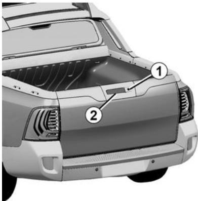
Destrave a tampa traseira utilizando a chave na fechadura **1**.
