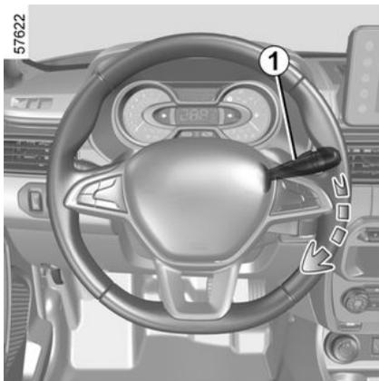
**Com a ignição ligada**, puxe a alavanca **1** e depois solte-a.
