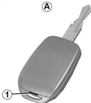
Ou deseneixe a tampa do controle remoto **A** com uma chave de fenda plana em **1**.
