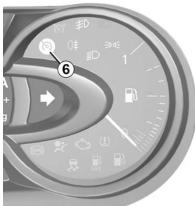
A uma velocidade estabilizada (superior a cerca de 30 km/h), pressione o interruptor **2** (+): a função é ativada e a velocidade atual é salva.
