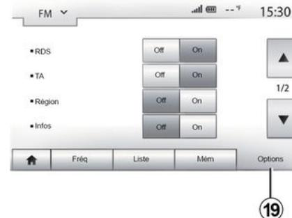
Exiba o menu de configuração pressionando **19**. Você pode ativar ou desativar funções pressionando "Ligar" ou "Desligar" (o menu de configuração muda de acordo com a faixa).
