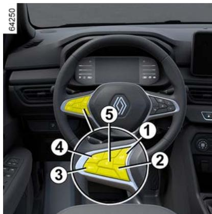
A função do limitador de velocidade é suspensa quando você pressiona o interruptor **5** (0). A velocidade limite é armazenada e exibida em cinza no painel de instrumentos.
