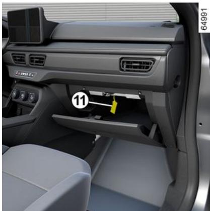
Desencaixe a tampa **11** com uma chave de fenda pressionando a lingueta de cada lado da luz.
