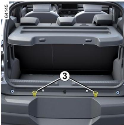
Pontos de ancoragem **3** localizados no porta-malas podem ser usados para ancorar a carga.
