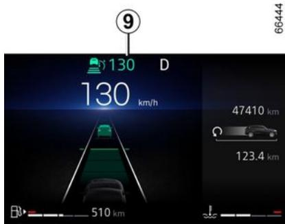
A velocidade de cruzeiro pode ser ultrapassada a qualquer momento acionando o pedal do acelerador.
