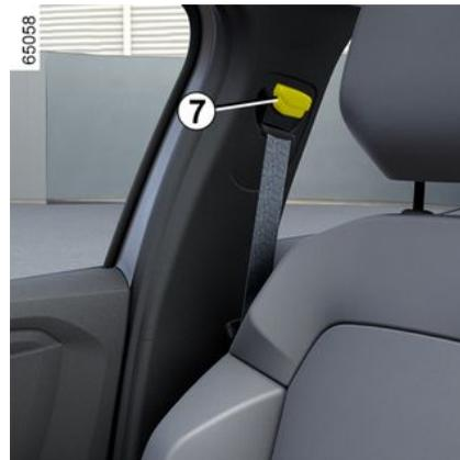
Desloque o botão **7** para selecionar sua posição de regulagem, de modo que a faixa torácica **1** fique conforme indicado anteriormente.
