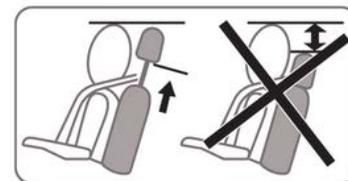
A posição totalmente abaixada do apoio de cabeça (posição 2) é uma **posição apenas para armazenamento**: não use essa posição quando o banco estiver ocupado.
