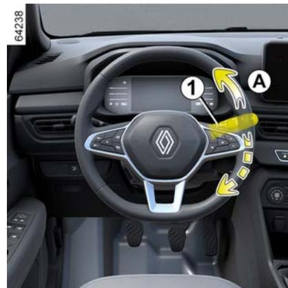
Esta posição permite levantar as palhetas para removê-las do para-brisas.
