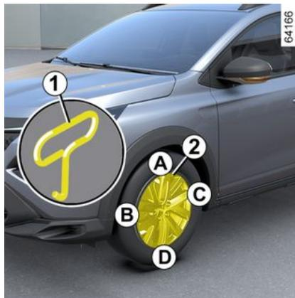
Retire com a chave de calota **1**, introduzindo a chave no orifício da válvula **2**.
