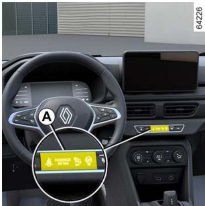
A luz indicadora **A** acende quando a ignição é acionada e apaga após alguns segundos.
