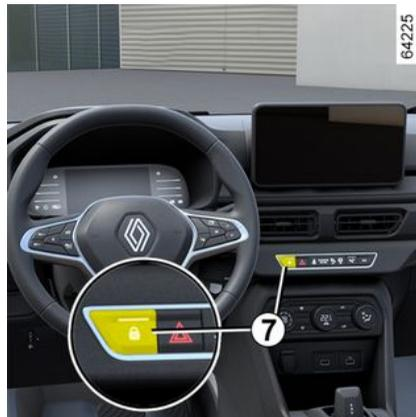
Conforme o veículo, permite o travamento ou destravamento simultâneo das quatro portas e da tampa do porta-malas. Para travar ou destravar as portas, pressione o interruptor **7**.
