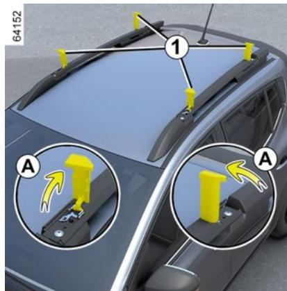
Se o veículo estiver equipado, esse dispositivo permite posicionar as barras de teto na posição longitudinal ou transversal.
