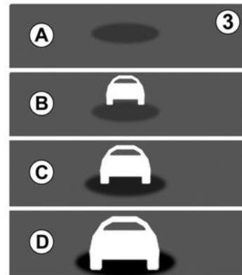
Com a função ativada, o indicador **3** é exibido no painel de instrumentos e informa o motorista da distância entre seu veículo e o veículo da frente.
