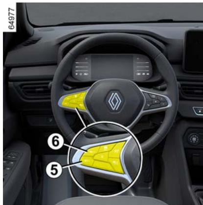
Você pode variar a velocidade pressionando repetidamente (para variação para baixo) ou pressionando e segurando (para variação para cima) o interruptor **5** ou **6** :
