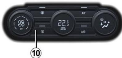
Pressione o botão **10** : a luz indicadora acima se acende. Esta função permite o descongelamento e o desembaçamento rápidos do vidro traseiro e o descongelamento dos retrovisores traseiros (se os veículos forem equipados com esta função).
