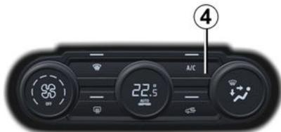
Em modo automático, o sistema controla a ativação e a desativação do ar condicionado em função das condições climáticas externas.
