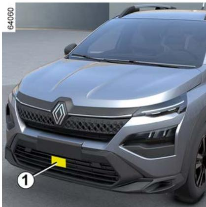
Certifique-se de que a área do sensor não esteja obstruída (por sujeira, lama, neve, uma placa de licença dianteira mal ajustada/instalada), impactada, modificada (incluindo pintura) ou escondida por qualquer acessório instalado na frente do veículo (na grade ou logotipo etc.).
