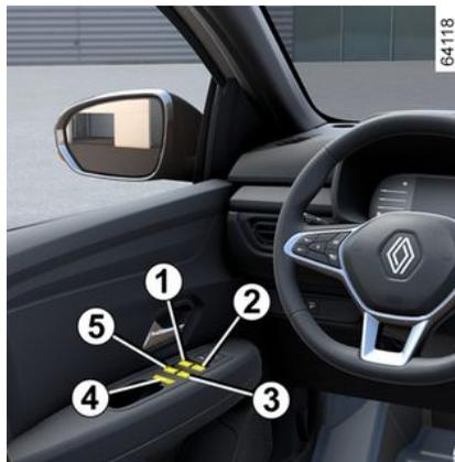
Os levantadores de vidros elétricos funcionam com a ignição ligada.
