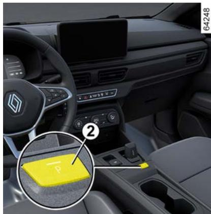
Com o veículo parado, o motor ligado ou a ignição ligada, pressione o botão **2** para acionar a posição **P**. A luz de aviso no botão **2** acenderá em laranja quando a caixa de velocidades estiver na posição de estacionamento **P**.
