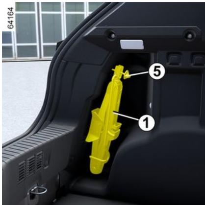
Para utilizar o macaco, desaperte a porca **5**. Contraia corretamente o macaco, antes de colocar de volta em seu alojamento. Aperte a porca **5** para fixar o macaco.
