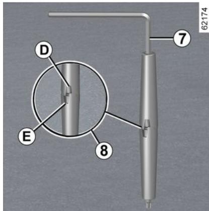
– use a ferramenta **7** para apertar os parafusos **2**: as marcas **D** e **E** lo-
