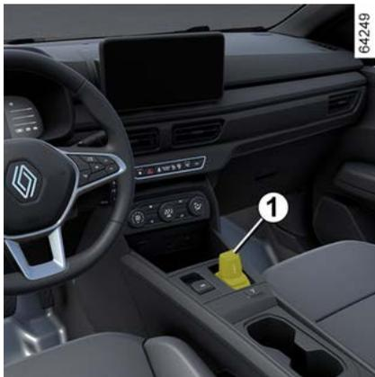
Movimente a alavanca de seleção **1** uma ou duas posições para frente ou para trás para engatar a posição desejada (**R**, **N**, ou **D**) e depois solte a
