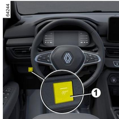
Pressione no interruptor **1** para desativar a função. A luz indicadora acima do interruptor **1** se acende. Uma nova pressão reativa o sistema. A luz indicadora acima do interruptor **1** se apaga.
