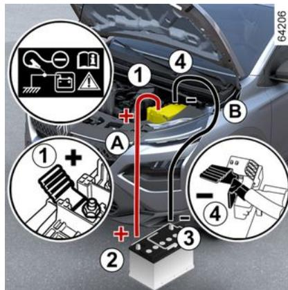
Conecte o cabo positivo (+) **A** ao terminal (+) **1** da bateria descarregada e, depois, ao terminal (+) **2** da bateria de alimentação de corrente.
