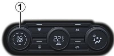
Em modo automático, o sistema controla a melhor velocidade de ventilação para atingir e manter o conforto.
