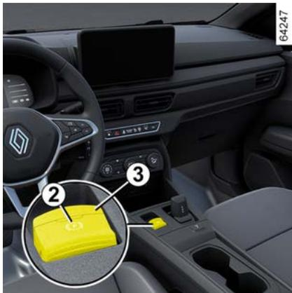
Para aplicar o freio de estacionamento eletrônico manualmente (ao parar no sinal vermelho ou parar com o motor funcionando, etc.): puxe e solte o interruptor **3**. O freio será liberado assim que for dada nova partida no veículo.
