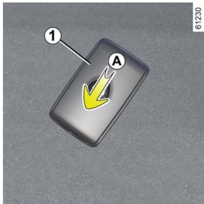
A chave **2** integrada é usada para travar ou destravar a porta dianteira esquerda se o cartão não funcionar.
