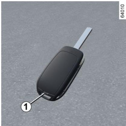
Abra a tampa pela abertura **1** usando uma chave de fenda de cabeça chata ou ferramenta semelhante e substitua a bateria **2**, respeitando o tipo e a polaridade gravada no fundo da tampa.
