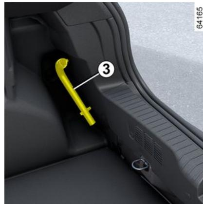
Trava ou destrava os parafusos da roda.
