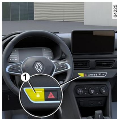
Após a partida do veículo, assim que ele atinge a velocidade de aproximadamente 10 km/h, o sistema trava automaticamente as portas.
