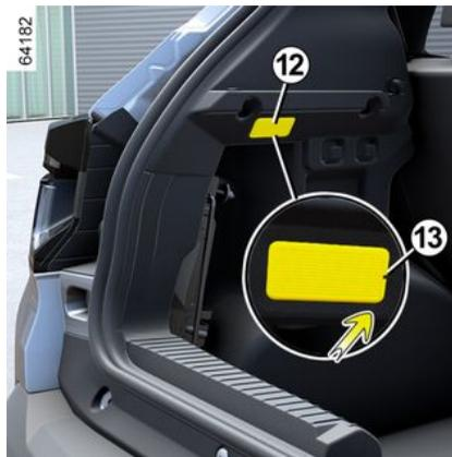
Desencaixe a luz do porta-malas **12** com uma ferramenta do tipo chave de fenda, pressionando a lingueta **13** para deslocar a tampa para o interior do porta-malas.
