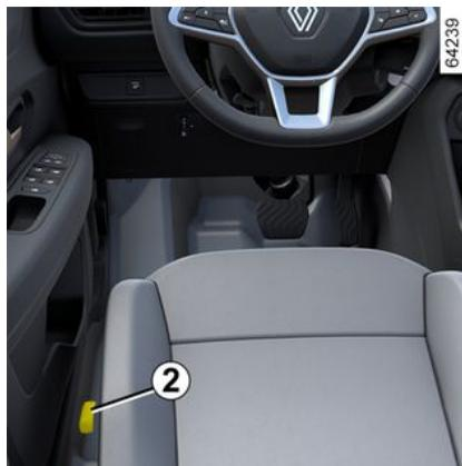
Puxe a alavanca **2**, para destravar a tampa do tanque de combustível **A**. Abra e desaperte o tampão do tanque de combustível **1**.
