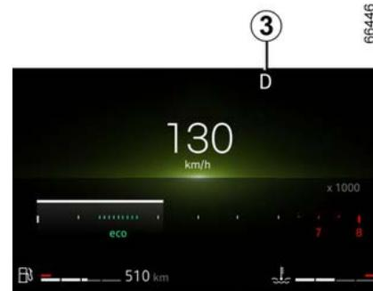
O visor 3 no painel de instrumentos informa a posição engatada da alavanca seletora 1
