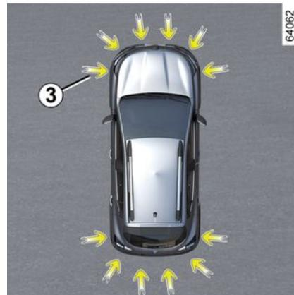
Os sensores por ultrassom, indicados por setas **3**, são instalados nos para-choques para medir a distância entre o veículo e um obstáculo.
