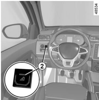
Se pressionar o interruptor **2**, o sistema é ativado e a mensagem "Ponto cego alerta ligado" aparece no painel de instrumentos.
