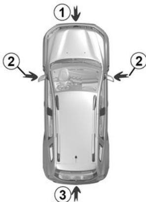
Se instaladas no veículo, as quatro câmeras **1**, **2** e **3**, que se encontram no para-choques dianteiro, nos retrovisores e na tampa da porta-malas, ajudam durante manobras difíceis.
