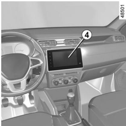
O modo automático é ativado quando a marcha à ré é engatada e a tela **4** mostra a vista a partir da câmera de vista traseira. Quando existe uma mudança rápida da velocidade de marcha à ré para uma velocidade de marcha em frente, a tela **4** mostra a imagem a partir da câmera frontal.
