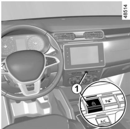
Após a partida do veículo, o sistema trava automaticamente as partes que podem ser abertas assim que o veículo atingir cerca de 7 km/h.
