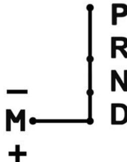
Com a alavanca seletora na posição D, mova a alavanca para a esquerda, para a posição M.
