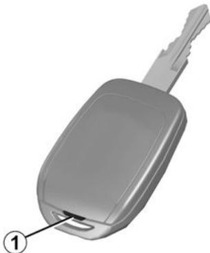
Abra a caixa pelo encaixe **1** usando uma chave de fenda de cabeça chata ou ferramenta semelhante e substitua a bateria **2**, respeitando o tipo e a polaridade gravada no fundo da tampa.
