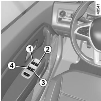
**Com a ignição ligada** e, dependendo do veículo, o motor funcionando, pressione o interruptor para baixar o vidro até a altura pretendida.
