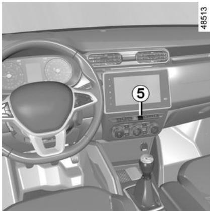
Conforme o veículo, permite o travamento ou destravamento simultâneo das quatro portas e da tampa do porta-malas. Para travar ou destravar as portas, pressione o interruptor **5**.
