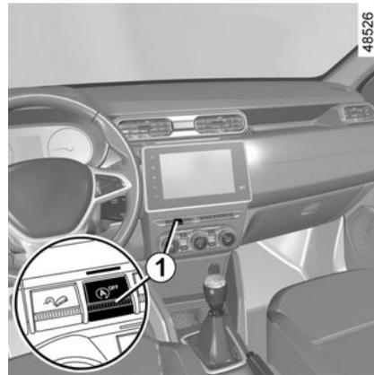
Pressione no interruptor **1** para desativar a função. A luz indicadora acima do interruptor **1** se acende.
