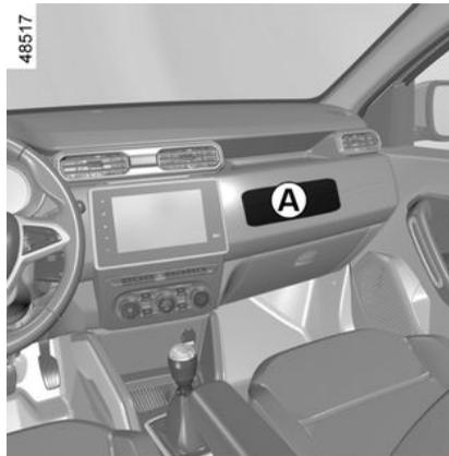
A presença deste equipamento é indicada pela palavra “airbag” no volante, no painel de bordo (na zona do airbag **A**) e, dependendo do veículo, em uma etiqueta na seção inferior do para-brisa.
