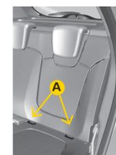
Existem dois sistemas de fixação de cadeirinhas infantis: o cinto de segurança e o sistema Isofix. No sistema Isofix temos 3 pontos de fixação. São duas argolas **A**, situadas entre o encosto e o assento do banco traseiro e identificadas com uma etiqueta no encosto, e o anel **C**, utilizado para prender a faixa superior da cadeirinha.
