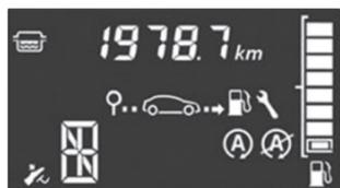
O indicador **(A)** ficará aceso de forma permanente no painel de instrumentos para alertar que o motor está em modo de espera. Para ligar o motor novamente, pressione o pedal da embreagem (para veículos com câmbio manual).
