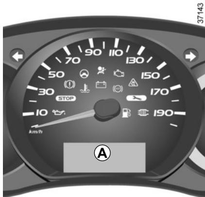
Com a ignição ligada, o relógio e a temperatura exterior, conforme a versão do veículo, são exibidas no computador de bordo **A**.
