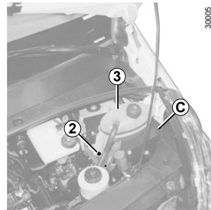
Posicione o reservatório de líquido de refrigeração 3, depois aperte o parafuso 2.
