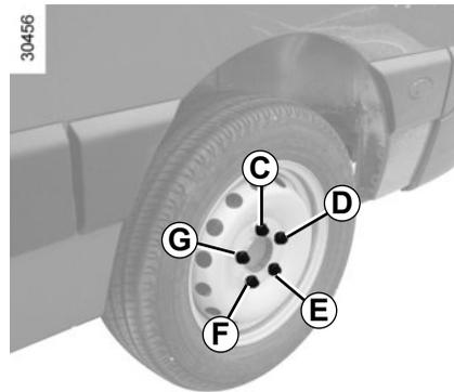
Com as rodas no solo, aperte fortemente os parafusos começando pelo lado **C**, depois **E**, **G**, **D** e termine em **F**. Assim que possível, mande verificar o aperto e a pressão de enchimento do estepe.
