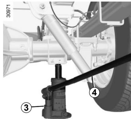
Comece a bombear ao manipular as extensões **4** colocadas ponta a ponta e disponíveis no bloco de ferramentas.
