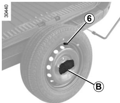
**Observação:** não coloque uma roda com aro da roda em alumínio no suporte do estepe.
