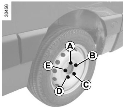
Com as rodas no solo, aperte fortemente os parafusos começando pelo lado **A**, depois **C**, **E**, **B** e termine em **D**. Assim que possível, mande verificar o aperto e a pressão de enchimento do estepe.
