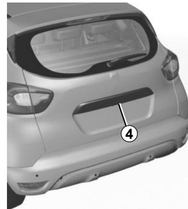
**Observação** você poderá enfrentar problemas temporários com o sistema de mãos livres se um dos sensores instalados na maçaneta da porta estiver obstruído por sujeira, terra, neve, sal, etc. Limpe os sensores. Dirija-se a uma Oficina Autorizada se o problema persistir.
