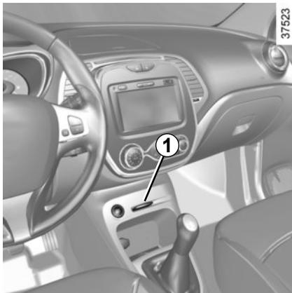
Antes de realizar qualquer procedimento de reboque, recoloca a alavanca em ponto morto (posição **N** para veículos equipados com câmbio automático).
