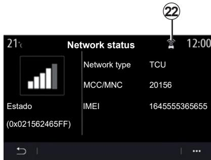
O estado e os dados de conexão informam sobre o estado, o nível de recepção **22** e o ID do sistema.
