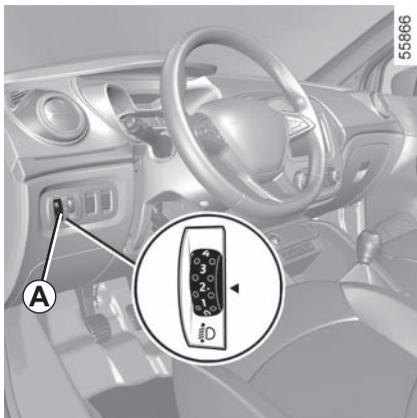
Para os veículos que dispõem deste equipamento, o comando **A** permite corrigir a altura dos faróis, em função da carga.
