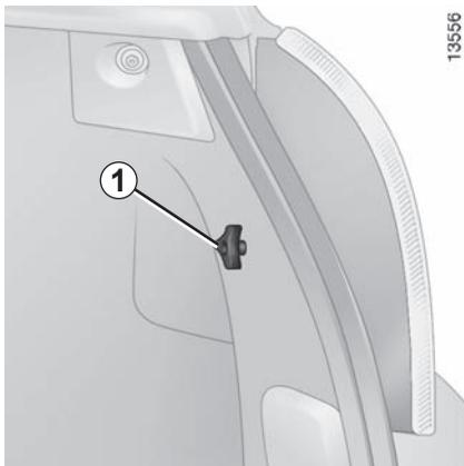
Retire os parafusos **1** e desencaixe o bloco das lanternas traseiras por fora.
