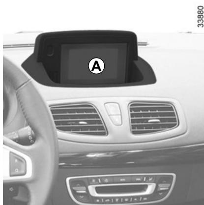
**Observação:** segundo o veículo, a tela **A** permite visualizar a zona envolvente do veículo em complemento dos bips.
