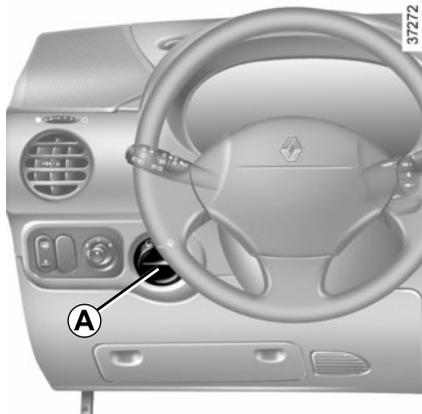
O comando **A** permite corrigir a altura dos faróis, em função da carga.
