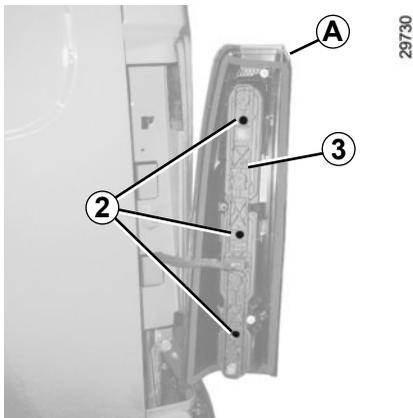
Desaperte os parafusos **2** com a chave plana / chave de fenda para retirar o porta-lâmpadas **3**.
