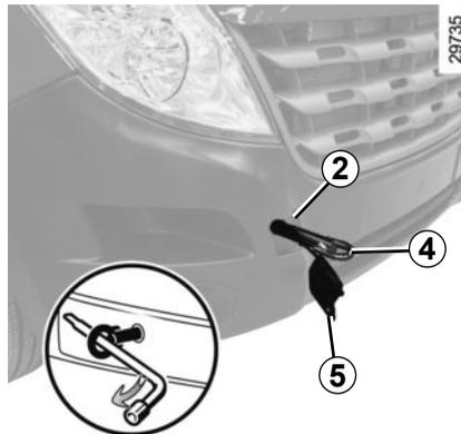
Aperte o anel de reboque 4 ao máximo: primeiro à mão até prender e depois termine apertando-o com a chave de roda situada no bloco de ferramentas 3.
