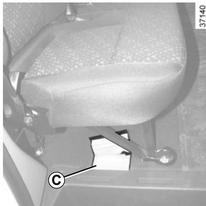
Para acessar a gravação do número VIN de seu veículo levantar a aba do tapete na posição indicada **C**.
