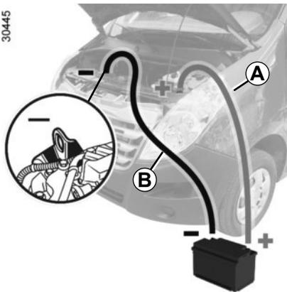
Fixe o cabo positivo (+) **A** à placa **3**, depois ao borne (+) **2** da bateria que fornece corrente.
