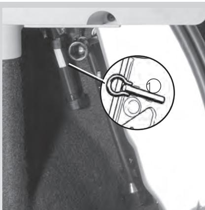
Caso seu veículo precise ser rebocado, o volante não deverá estar travado, a chave de ignição precisará estar na posição (M) permitindo a sinalização (luzes, freios, indicadores de direção). À noite, o veículo deve estar iluminado.
