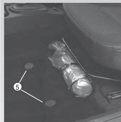
Para garantir a correta fixação do tapete de borracha no piso do assento do motorista, existem em seu veículo pequenos pinos de fixação (5), que evitarão que o tapete se desloque durante a condução do automóvel.
