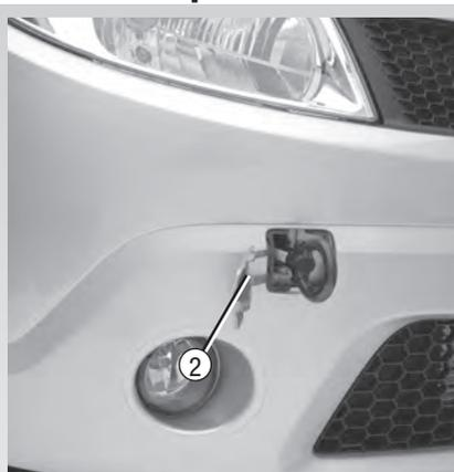
Utilize exclusivamente o anel de reboque (1), situado no porta-malas, e o ponto de reboque dianteiro (2) e traseiro (3) (veja página seguinte). Nunca reboque um veículo por seu eixo de transmissão. Esses pontos de reboque só podem ser usados para rebocar o veículo, nunca para levá-lo direta ou indiretamente.
