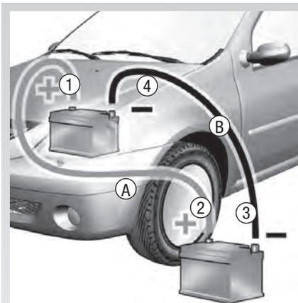
Fixe o cabo positivo (+) (A) ao borne (+) **1** da bateria descarregada e, em seguida, ao borne (+) **2** da bateria que fornece a energia.
