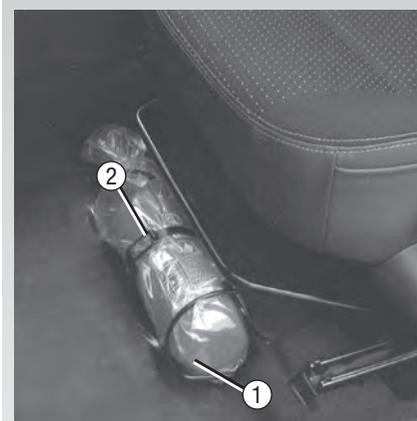
O extintor de incêndio (1), posicionado sob o banco do motorista, é fixado de modo a permitir acesso fácil e rápido.
