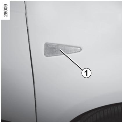
Desencaixe o pisca-pisca **1** (com auxílio de uma ferramenta tipo chave de fenda).
