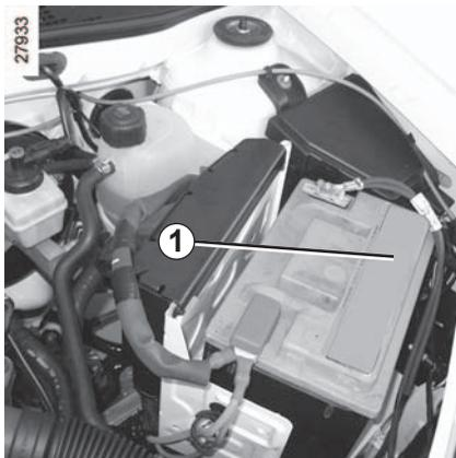
A bateria pode ser do tipo com ou sem manutenção, conforme a versão do veículo.
