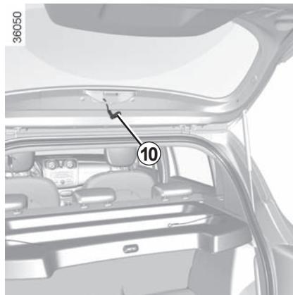
Gire o porta-lâmpadas 10 um quarto de volta, desencaixe e retire a lâmpada.
