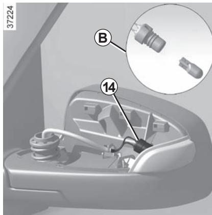
Desplugue o soquete do repetidor **14**, como indicado em **B** e substitua a lâmpada.
