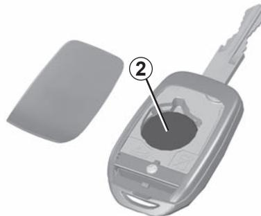
Substitua a bateria 2, observando o modelo e a polaridade gravada na tampa.
