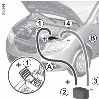
Fixe o cabo positivo (+) **A** ao borne (+) **1** da bateria descarregada, depois ao borne (+) **2** da bateria de alimentação de corrente.
