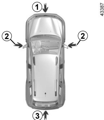
Se instaladas no veículo, as quatro câmeras **1**, **2** e **3**, que se encontram no para-choques dianteiro, nos retrovisores e na tampa da porta-malas, ajudam durante manobras difíceis.
