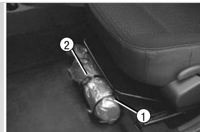
O extintor de incêndio (1), posicionado sob o banco do motorista, é fixado de forma que permita um acesso fácil e rápido. Ao puxar a presilha da braçadeira (2), o extintor de incêndio é liberado.
