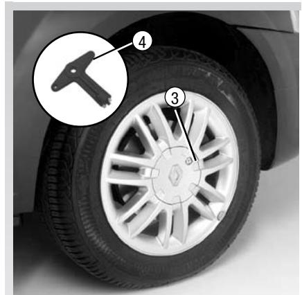
Retire a calota central com auxílio da chave (4) no ponto (3).
