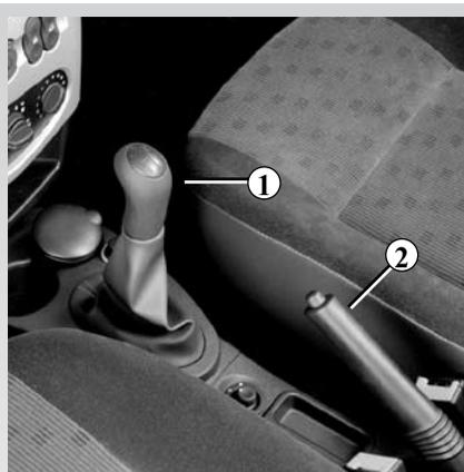
Para engatar a marcha à ré (veículo parado). Coloque a alavanca na posição neutra (ponto morto); em seguida, puxe a alavanca gentilmente para a direita e para trás, até a posição de marcha à ré. As luzes de marcha à ré acendem-se logo que esta é engatada (ignição ligada).
