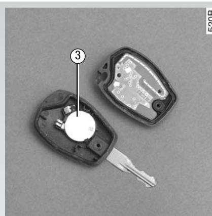
Substitua a pilha (3) atentando para a polaridade gravada na tampa
