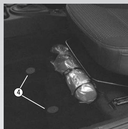
Para garantir a correta fixação do tapete de borracha no piso do assento do motorista, existem em seu veículo pequenos pinos de fixação (4), que evitarão que o tapete se desloque durante a condução do automóvel.
