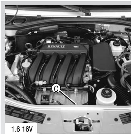
C - Placa do motor ou etiqueta do motor. (A localização varia em função do motor)
