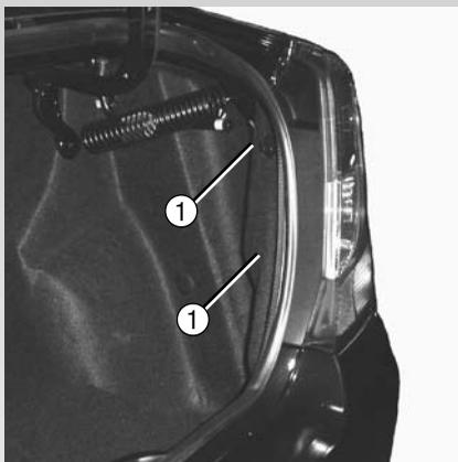
Retire os parafusos (1) e retire a lanterna traseira inteira.
