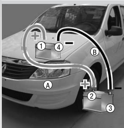
Fixe o cabo positivo (+) (A) ao borne (+) (1) da bateria descarregada e, em seguida, ao borne (+) (2) da bateria que fornece a energia.
