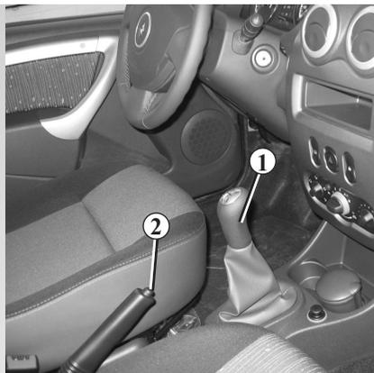
Para engatar a marcha à ré (veículo parado). Coloque a alavanca (1) na posição neutra (ponto morto); em seguida, puxe a alavanca gentilmente para a direita e para trás, até a posição de marcha à ré.
