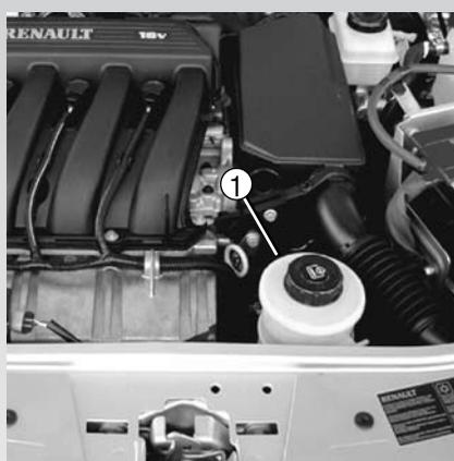
**Reservatório de fluido de direção hidráulica.**
