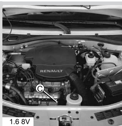
C - Placa do motor ou etiqueta do motor. (A localização varia em função do motor)
