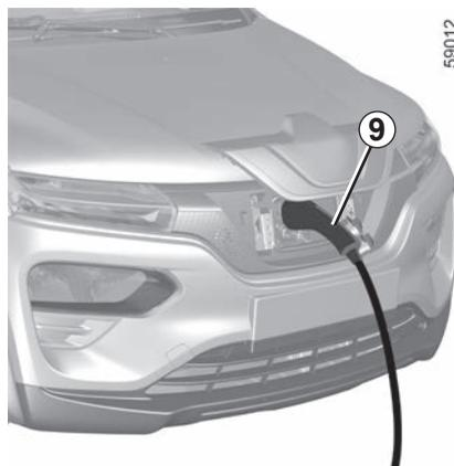
Para carregamento rápido (DC) do veículo, o comprimento do cabo de carregamento entre o veículo e a estação de carregamento não deve exceder **30 metros**.
