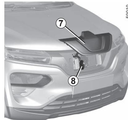
O cabo de carregamento é automaticamente travado com o veículo. Isso tornará impossível a desconexão do cabo do veículo.
