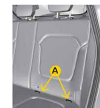
Existem dois sistemas de fixação de cadeirinhas infantis: o cinto de segurança e o sistema ISOFIX. No sistema ISOFIX temos 3 pontos de fixação. São duas argolas **A**, situadas entre o encosto e o assento do banco traseiro e identificadas com uma etiqueta no encosto, e o anel **C**, utilizado para prender a faixa superior da cadeirinha.
