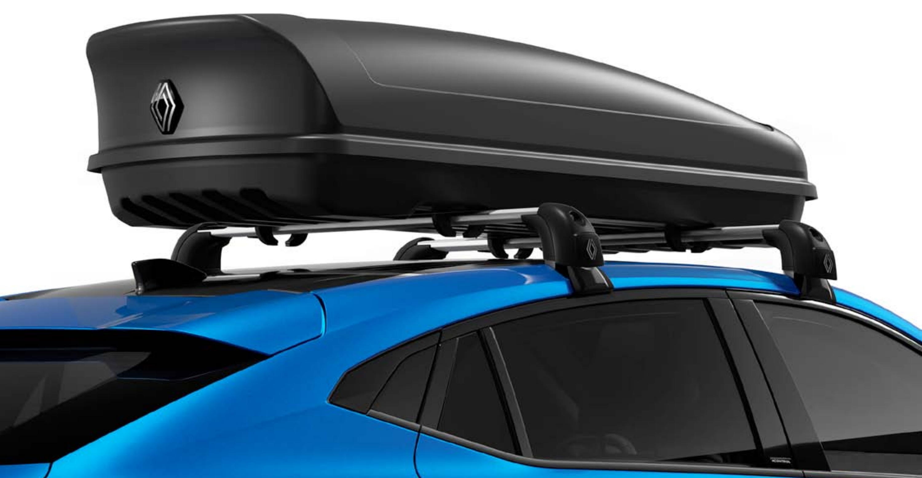
480 l fassende Renault Dachbox auf den Dachträgern
