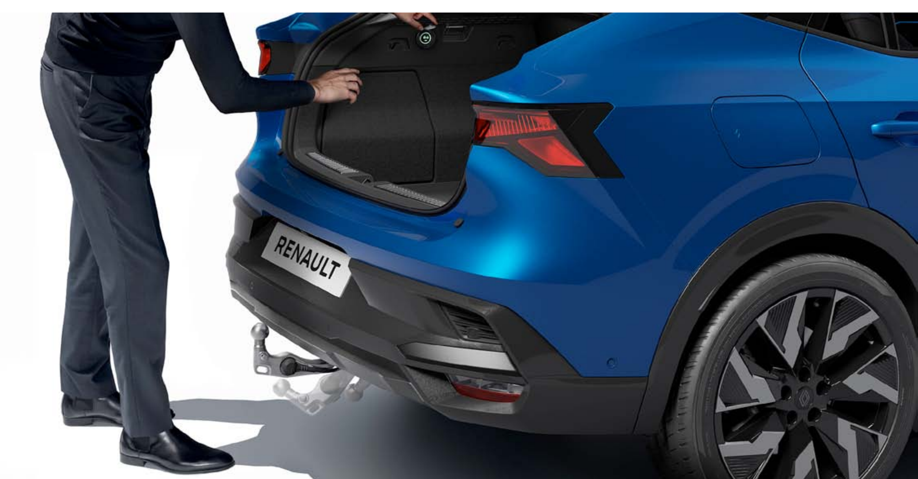
elektrisch einklappbare Anhängerkupplung
