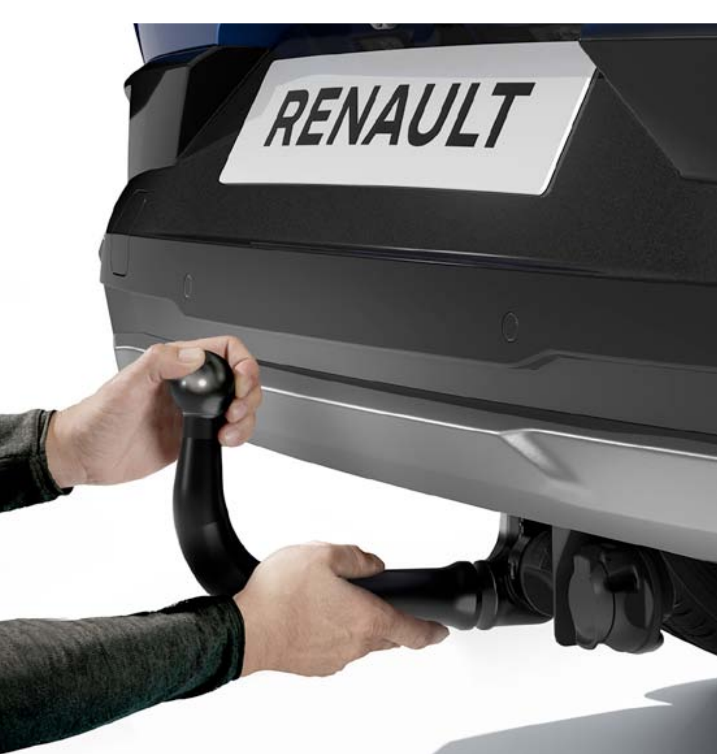
ohne Werkzeug abnehmbare Anhängerkupplung
