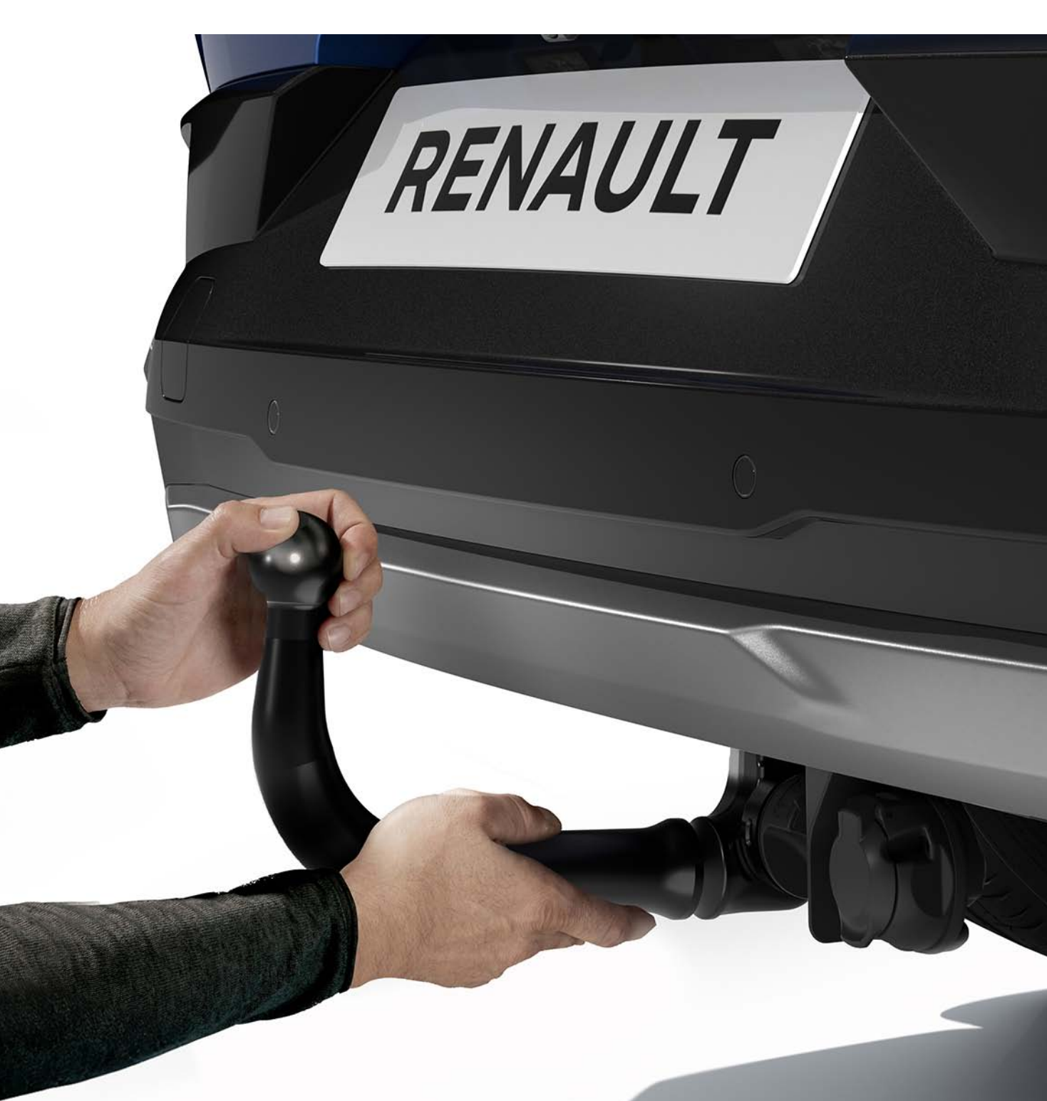
ohne Werkzeug abnehmbare Anhängerkupplung
