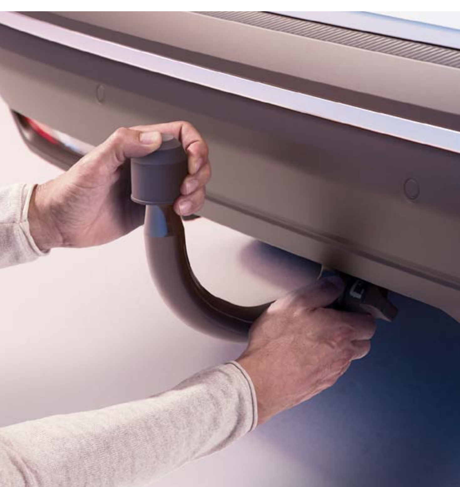
ohne Werkzeug abnehmbare Anhängerkupplung
