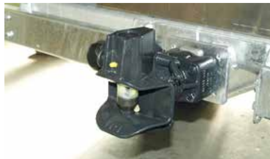
No. art. Alaskan PL 8.03 Dispositif d'attelage système automatique (type Rockinger)
