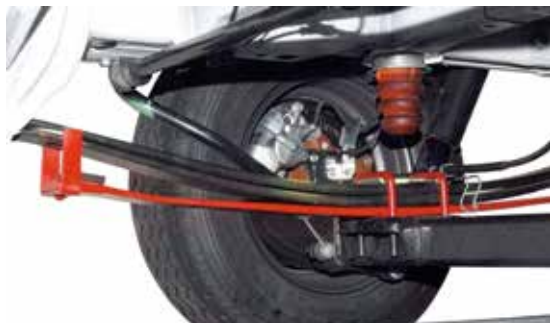
No. art. Alaskan PL 7.02 Augmentation de charge pour King-Cab avec lame supplémentaire (photo exemple)
