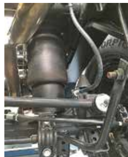
No. art. Alaskan PL 7.03 Augmentation de charge pour Double-Cab avec suspension à air au lieu de ressorts hélicoïdaux
