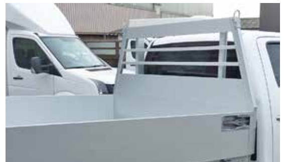
Pour comparaison, paroi frontale pour pont en aluminium, adaptée à la cabine, pour des charges légères
