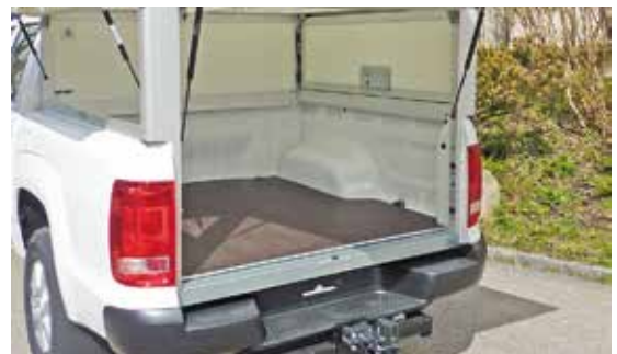
No. art. Alaskan PL 5.04 Plancher en bois contreplaqué imperméable
