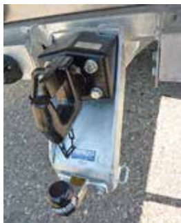
No. art. Alaskan PL 8.04 Dispositif d'attelage avec support combiné, avec crochet militaire et boule
