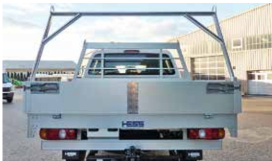
No. art. Alaskan PL 6.06 Porte-perches arrière, en acier zingué forme adaptée à la cabine
