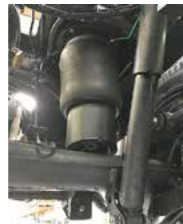
No. art. Alaskan PL 7.03 Augmentation de charge pour Double-Cab avec suspension à air au lieu de ressorts hélicoïdaux
