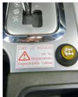
No. art. Alaskan 9.06 Intervention dans la traction par le différentiel, en cas de charges remorquables élevées
