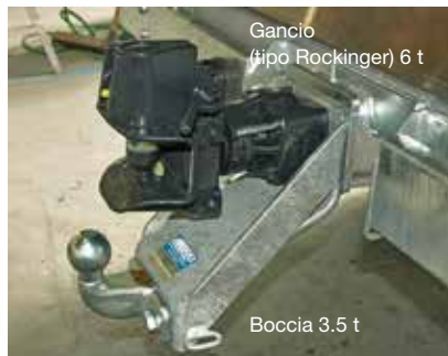
No. art. Alaskan PL 9.04 Gancio con supporto combinato Attenzione : varia il carico rimorchiabile
