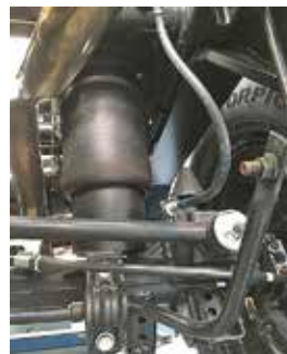
No. art. Alaskan PL 7.03 Esecuzione per l'aumento per Double-Cab con sospensione ad aria al posto di una a molle
