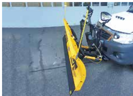
Montaggio di un spazzaneve
