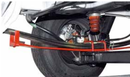
No. art. Alaskan PL 7.02 Esecuzione per l'aumento per King-Cab con lama per balestra addizionale (foto esemplare)
