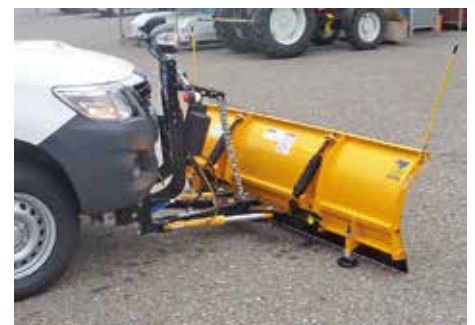
Montaggio di un spazzaneve
