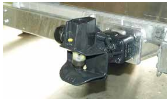
No. art. Alaskan PL 8.03 Gancio con sistema automatico (tipo Rockinger)
