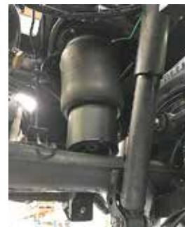
No. art. Alaskan PL 7.03 Esecuzione per l'aumento per Double-Cab con sospensione ad aria al posto di una a molle
