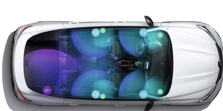
2 tweeters sur les côtés du tableau de bord, 4 woofers dans les panneaux des portes avant et arrière, 2 tweeters dans les panneaux des portes arrière et 1 subwoofer dans le coffre.
