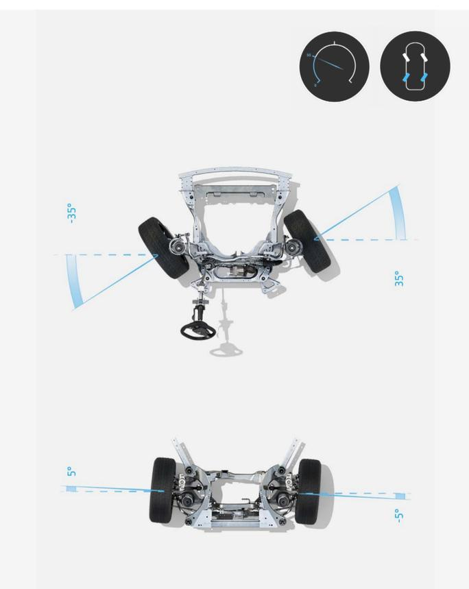
jusqu'à 50 km/h, les roues arrière tournent dans le sens opposé des roues avant pour réduire le diamètre de braquage
