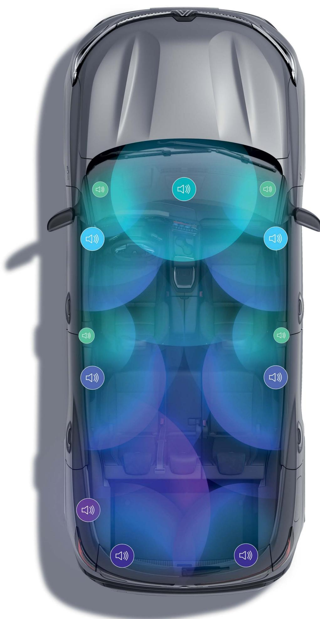
2 tweeters sur les côtés du tableau de bord, 2 woofers dans les panneaux de porte avant et 2 dans les panneaux de porte arrière, 2 surround, 1 unité centrale avant, 2 tweeters et 1 subwoofer dans le coffre
