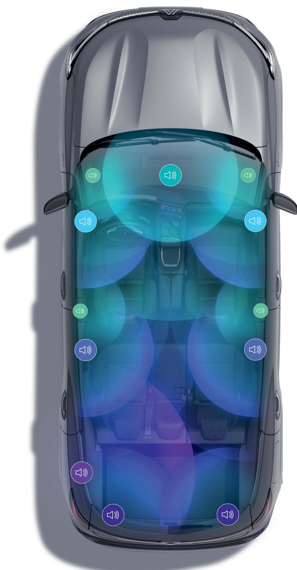
2 tweeter ai lati della plancia, 2 woofer nei pannelli delle porte anteriori e 2 nei pannelli delle porte posteriori, 2 altoparlanti surround, 1 unità centrale anteriore, 2 tweeter e 1 subwoofer nel bagagliaio
