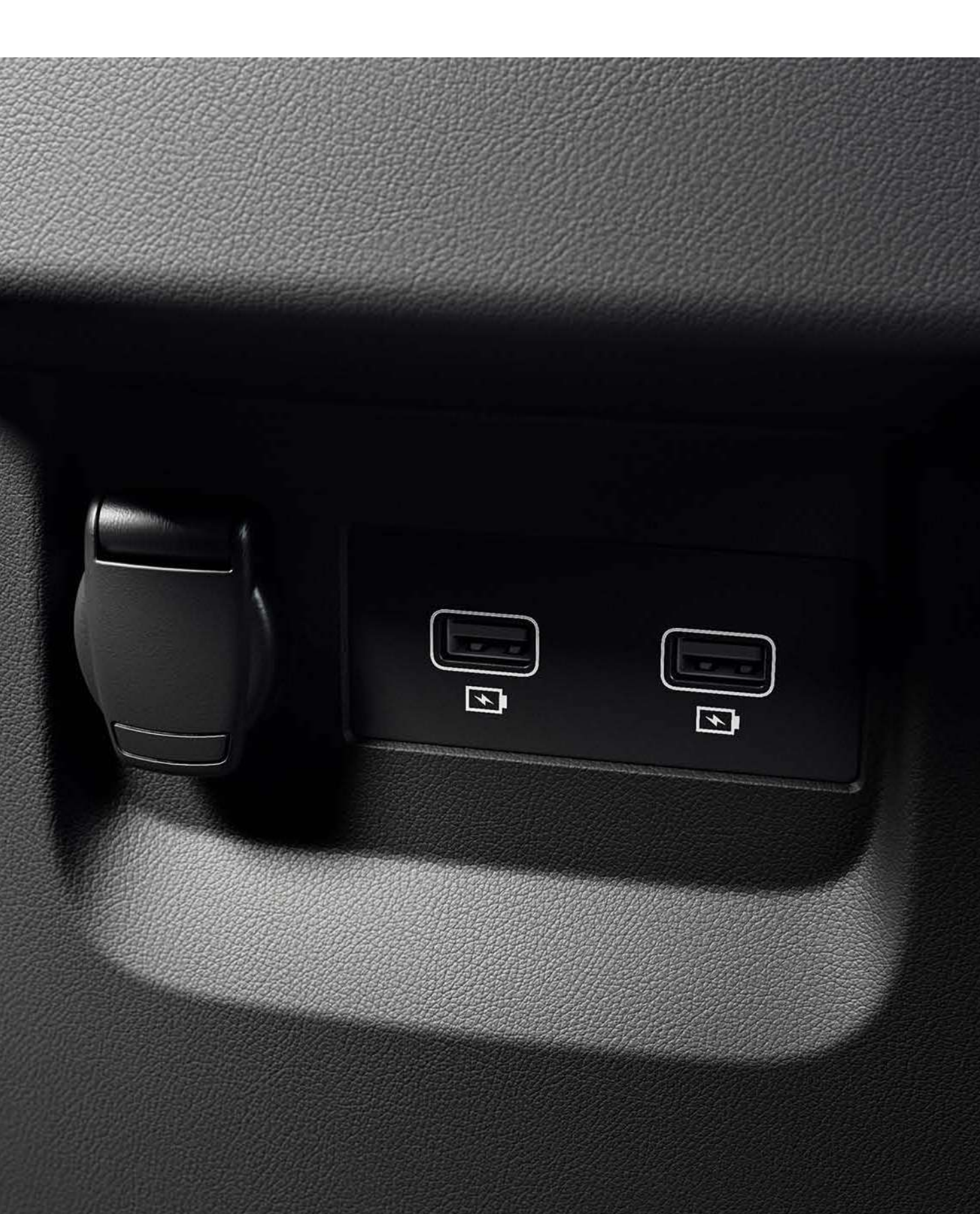
2 prese USB e 1 presa da 12 V per i passeggeri dei sedili posteriori
