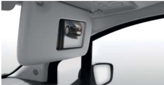
**konvexer Weitwinkelspiegel.** Der konvexe Weitwinkelspiegel in der Sonnenblende auf Beifahrerseite verbessert die Sicht und minimiert das Risiko von Kollisionen aufgrund des toten Winkels an Y-förmigen Kreuzungen.
