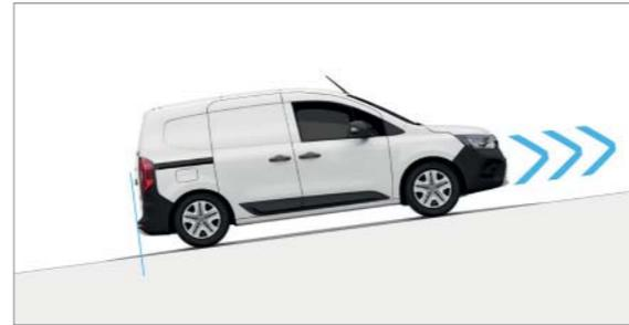
**Berganfahrhilfe.** Die ans ESC gekoppelte Berganfahrhilfe bewirkt, dass der Bremsdruck für 2 Sekunden automatisch aufrechterhalten wird, damit Sie Zeit haben, den Fuß vom Bremspedal zu nehmen und aufs Gaspedal zu drücken. Das System ist ab einer Steigung von 3% aktiviert.
