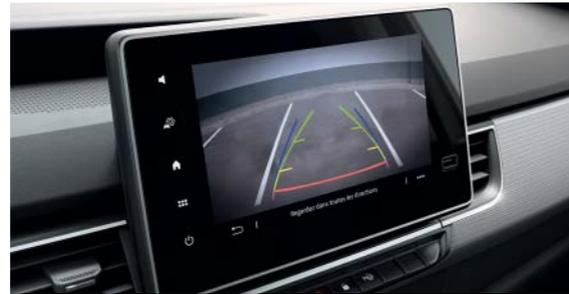
**Rückfahrkamera.** Sie überträgt ein Bild der Situation hinter dem Fahrzeug auf den Bildschirm des Multimediasystems Easy Link oder auf den Rückspiegel, sobald Sie den Rückwärtsgang einlegen. Eingblendete Fahrspuren vereinfachen das Manövrieren und machen es sicherer.
