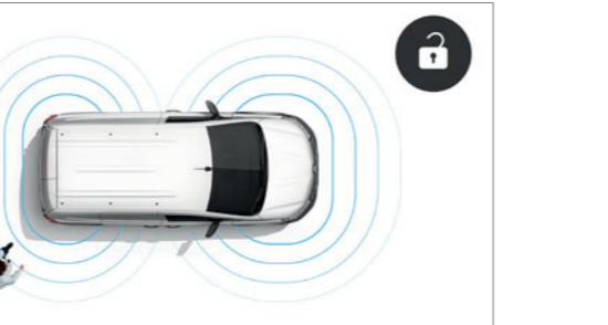
**fonction «zoning».** Elle permet de (dé)verrouiller soit les portes avant, soit la zone de chargement.
