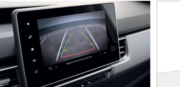
**caméra de recul.** Elle retransmet sur l'écran easy link ou dans le rétroviseur intérieur une vue de l'arrière lorsque vous enclenchez la marche arrière. Des gabarits facilitent et sécurisent vos manœuvres.
