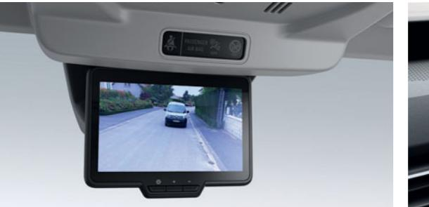
**assistance de vision arrière permanente.** Via un écran digital - en lieu et place du rétroviseur intérieur - elle vous permet de visualiser ce que capte la caméra installée à l'arrière de votre véhicule tôle.
