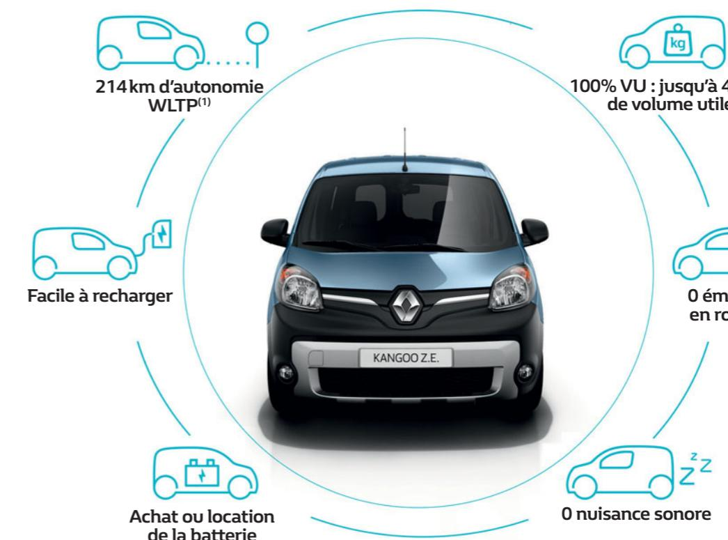
Pour aller plus loin, Renault Kangoo Z.E. dispose de la batterie Z.E. 33 (33 kWh), associée à un moteur 44 kW à haute efficacité énergétique, lui permettant de bénéficier d'une autonomie de 214 km WLTP<sup>(1)</sup>.
