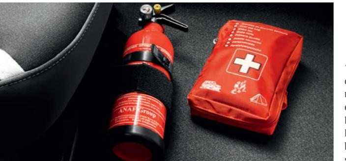
**1. Aide au parking.** Disponible pour l'avant ou l'arrière, l'aide au parking facilite les manœuvres. **2. Support extincteur.** Les extincteurs disponibles dans la gamme Renault se montent sur ce support adapté. Fixé au sol sur le côté passager, il a fait l'objet de crash tests pour garantir la sécurité des occupants.
