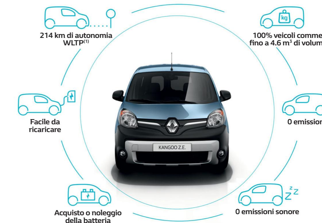
Per andare più lontano, Renault Kangoo Z.E. è dotato della batteria Z.E. 33 (33 kWh), associata a un motore da 44 kW ad alta efficienza energetica, che gli consente di disporre di una autonomia di 214 km nel WLTP<sup>(1)</sup>.
