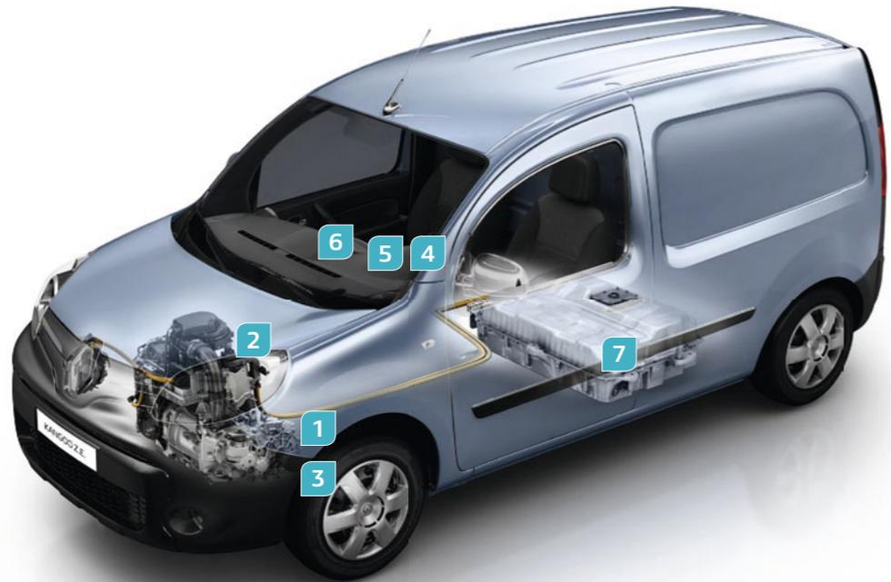
**1) Impianto frenante rigenerativo:** la batteria si ricarica mentre sollevate il piede dall'acceleratore o anche mentre lo appoggiate sul pedale del freno.
