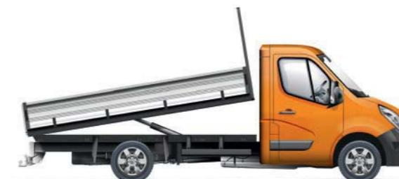
Benne basculante arrière
