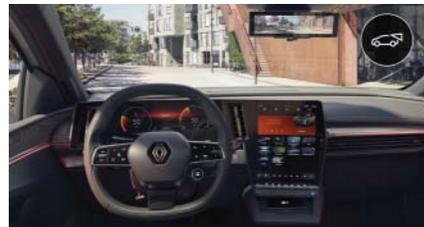
**Innenspiegel mit Heckkamera-Display.** Auf dem Innenspiegel wird eine Komplettansicht der Umgebung hinter dem Fahrzeug abgebildet.
