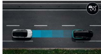
**Adaptiver Tempomat.** Er hält einen angemessenen Sicherheitsabstand zum vorausfahrenden Fahrzeug ein. Wenn die Distanz zu gering ist, betätigt das System die Bremse und sobald die Spur wieder frei ist, das Gaspedal.
