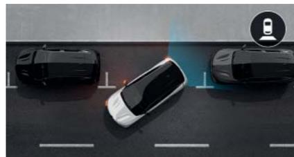
**Rückfahrkamera.** Sie überträgt ein Bild der Situation hinter dem Fahrzeug auf den Bildschirm, sobald Sie den Rückwärtsgang einlegen. Eingblendete Fahrspuren vereinfachen das Manövrieren und machen es sicherer.
