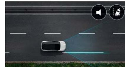
**Spurhaltewarner (Lane Departure Warning).** Er warnt den Fahrer, wenn eine unterbrochene oder durchgezogene Linie überfahren wird, sofern der Blinker nicht gesetzt wurde.
