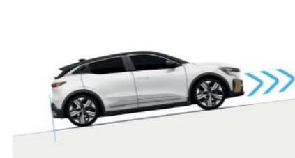
**Berganfahrhilfe.** Sie wird bei einer Steigung über 3% aktiviert und hält den Bremsdruck während 2 Sekunden aufrecht.
