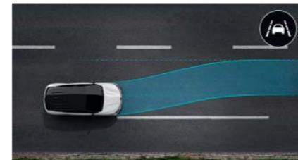
**Spurhalteassistent.** Das System greift korrigierend ins Lenkrad ein, um das Fahrzeug in der Spur zu halten, sofern Sie den Blinker nicht gesetzt haben.
