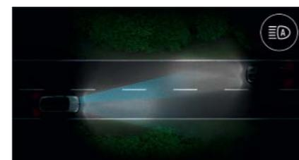
**Automatisches Umschalten von Fernlicht/Abblendlicht.** Das Umschalten wird aufgrund einer Kamera umgesetzt, die die Lichtverhältnisse je nach Beleuchtung und Verkehr analysiert.
