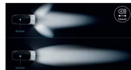
**LED-Scheinwerfer mit adaptivem Frontlichtsystem (und integrierten Nebelleuchten).** Das System passt die Form des Lichtkegels automatisch an die Verkehrs- und Wittersituation an.
