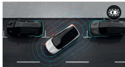
**3D-Kamera mit 360°-Sicht.** 4 Kameras bilden die direkte 360°-Umgebung des Fahrzeugs ab, damit Sie problemlos manövrieren können.
