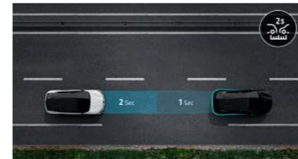
**Automatischer Abstandsanzeiger.** Der Sensor vorne berechnet den Sicherheitsabstand zum vorausfahrenden Fahrzeug und warnt Sie akustisch und visuell, wenn ein Kollisionsrisiko besteht.
