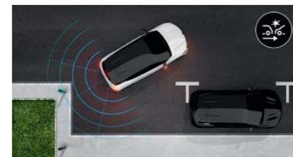
**Automatischer Notbremsassistent im Rückwärtsgang.** Das System erkennt Hindernisse hinter dem Fahrzeug und bringt es bei Gefahr automatisch zum Stillstand.
