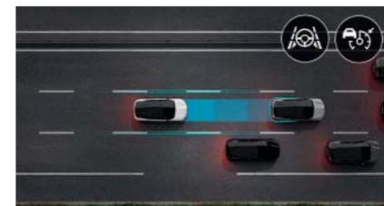
**Active Driver Assist.** Das System berücksichtigt Rahmenbedingungen der Route, um die Geschwindigkeit zu kontrollieren, den Sicherheitsabstand einzuhalten und eine Fahrt in der Spurmitte sicherzustellen. Bei stockendem Verkehr kommt das Fahrzeug zum Stillstand und fährt auch automatisch wieder an.
