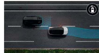
**Toter-Winkel-Assistent mit aktivem Lenkeingriff.** Die Fahrspur des Fahrzeugs wird automatisch korrigiert, wenn bei einem Spurwechsel ein Kollisionsrisiko besteht.
