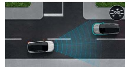
**Aktiver Notbremsassistent.** Der Assistent erkennt Fahrzeuge, die frontal oder seitlich auftauchen, und bringt ihr Fahrzeug bei Gefahr zum Stillstand.
