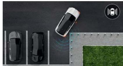
**Einparkhilfe seitlich.** Sensoren erleichtern Ihnen das Manövrieren, indem sie Ihnen durch akustische und visuelle Signale die Distanz zu Hindernissen seitlich vom Fahrzeug vermitteln.
