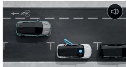
**Ausstiegsassistent.** Das System warnt Sie, wenn sich von hinten ein Fahrzeug nähert und Sie gerade die Tür öffnen wollen.
