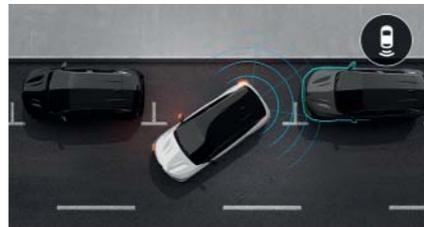
**Einparkhilfe hinten.** Sensoren erleichtern Ihnen das Manövrieren, indem sie Ihnen durch akustische und visuelle Signale die Distanz zu Hindernissen hinter dem Fahrzeug vermitteln.
