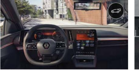
**rétrovision par caméra.** Elle retransmet sur votre rétroviseur intérieur une vue complète de l'arrière.
