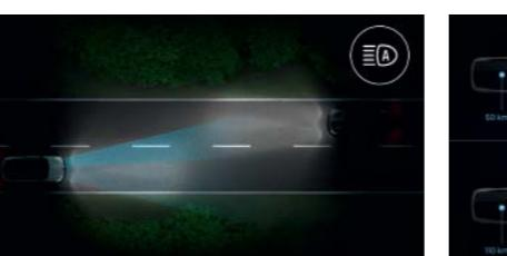
**commutation automatique des feux de route/croisement.** Elle s'effectue grâce à une caméra qui analyse les flux lumineux en fonction des conditions d'éclairage et de circulation.
