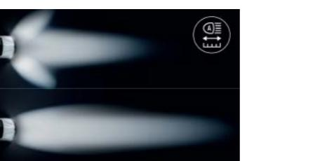
**feux LED adaptive vision (avec fonction antibrouillard intégrée).** Le système ajuste automatiquement la forme du faisceau lumineux à la situation du trafic et de la météo.
