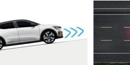
**aide au démarrage en côte.** Elle s'active lorsque la pente est supérieure à 3% en permettant à la pression de freinage d'être maintenue pendant 2 secondes.
