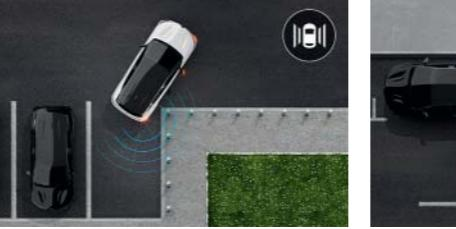
**aide au parking latérale.** Les radars facilitent vos manœuvres en signalant via des signaux acoustiques et visuels la proximité d'obstacles situés sur vos côtés.
