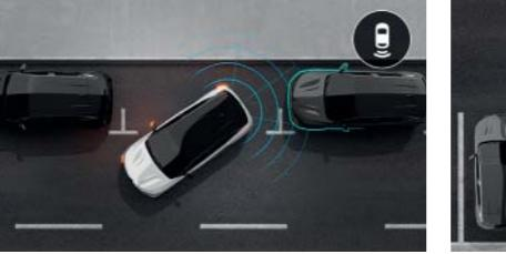
**aide au parking arrière.** Les radars facilitent vos manœuvres en signalant via des signaux acoustiques et visuels la proximité d'obstacles à l'arrière.
