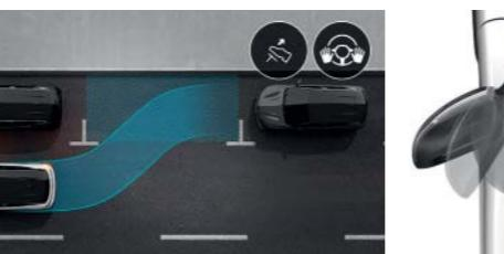
**advanced park assist.** Il identifie et mesure votre emplacement de parking, et effectue la manœuvre automatiquement. Il vous suffit de gérer l'allure.
