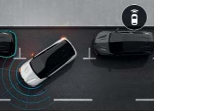
**aide au parking avant.** Les radars facilitent vos manœuvres en signalant via des signaux acoustiques et visuels la proximité d'obstacles situés devant vous.
