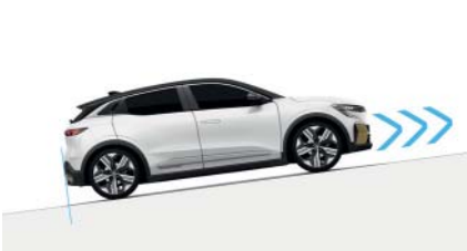
assistenza alla partenza in salita. Si attiva quando la pendenza è superiore al 3%, permettendo di mantenere la pressione di frenata per 2 secondi.
