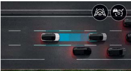
active driver assist. Regola la velocità tenendo presente l'ambiente stradale, mantiene le distanze di sicurezza e assicura il centraggio della corsia. In caso di traffico lento, il veicolo si ferma e si riavvia automaticamente.
