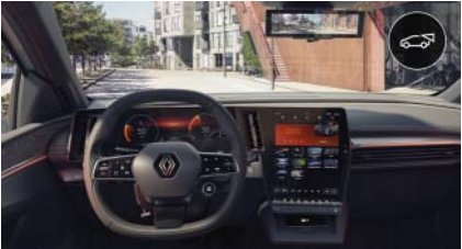
retrovisore interno con funzione camera digitale. Trasmette una visione completa della parte posteriore al vostro retrovisore interno.
