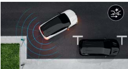
sistema di frenata automatica di emergenza in retromarcia. Rileva gli ostacoli nella parte posteriore e arresta automaticamente il veicolo in caso di pericolo.
