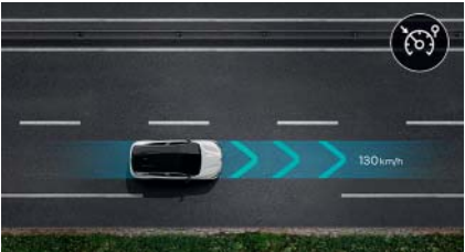
regolatore-limitatore di velocità. Il regolatore controlla la velocità. Il limitatore consente d'impostare una velocità massima.
