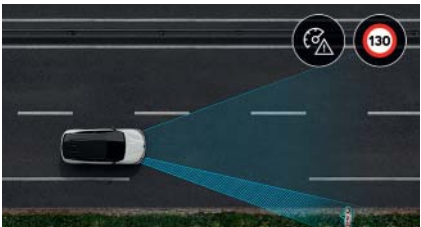
riconoscimento dei segnali stradali con avviso di superamento della velocità. Vi segnala i limiti di velocità avvisandovi in caso di loro superamento.
