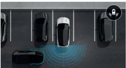
avvertenza traffico perpendicolare. Vi avverte della presenza di ostacoli nell'angolo posteriore del veicolo.
