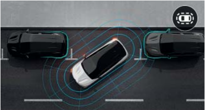
telecamera 3D con visione a 360°. Le 4 telecamere, le cui immagini ricostituiscono le immediate vicinanze del veicolo a 360°, vi permettono di fare le manovre senza sforzo.
