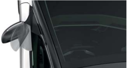
retrovisori esterni ripiegabili con funzione memory. Si ripiegano automaticamente, ricordando il vostro profilo e la funzione di inclinazione in retromarcia.
